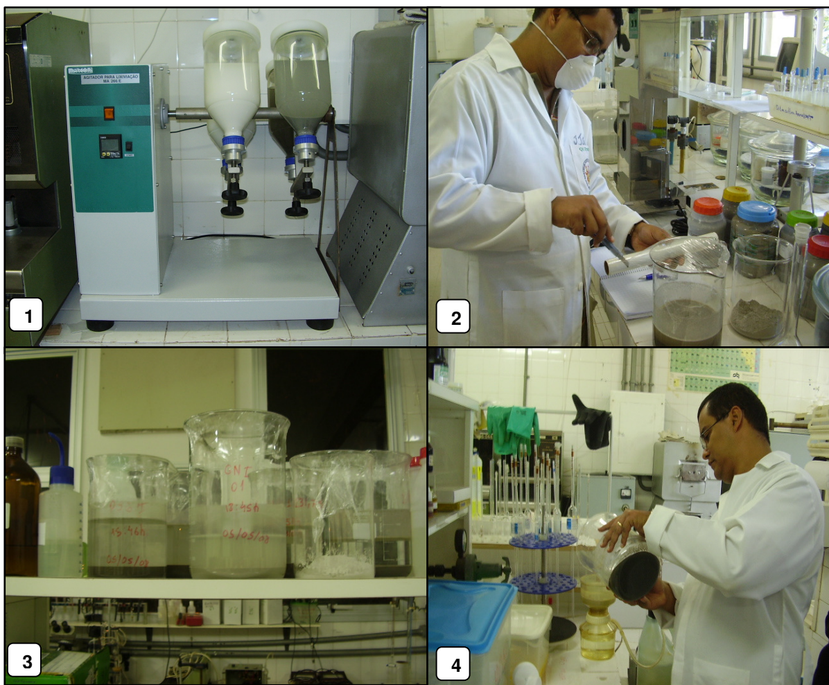
Figura 27- Em 1, pré-agitação em ensaio de solubilização, para evitar estratificação do resíduo, em agitador artesanal, feito com motor de pára-brisa veicular; em 2, selagem do frasco de solubilização residual a passar pelo ensaio de solubilização; em 3, amostras em ensaio de solubilização; em 4, obtenção do extrato solubilizado em aparelho de filtragem a vácuo.
