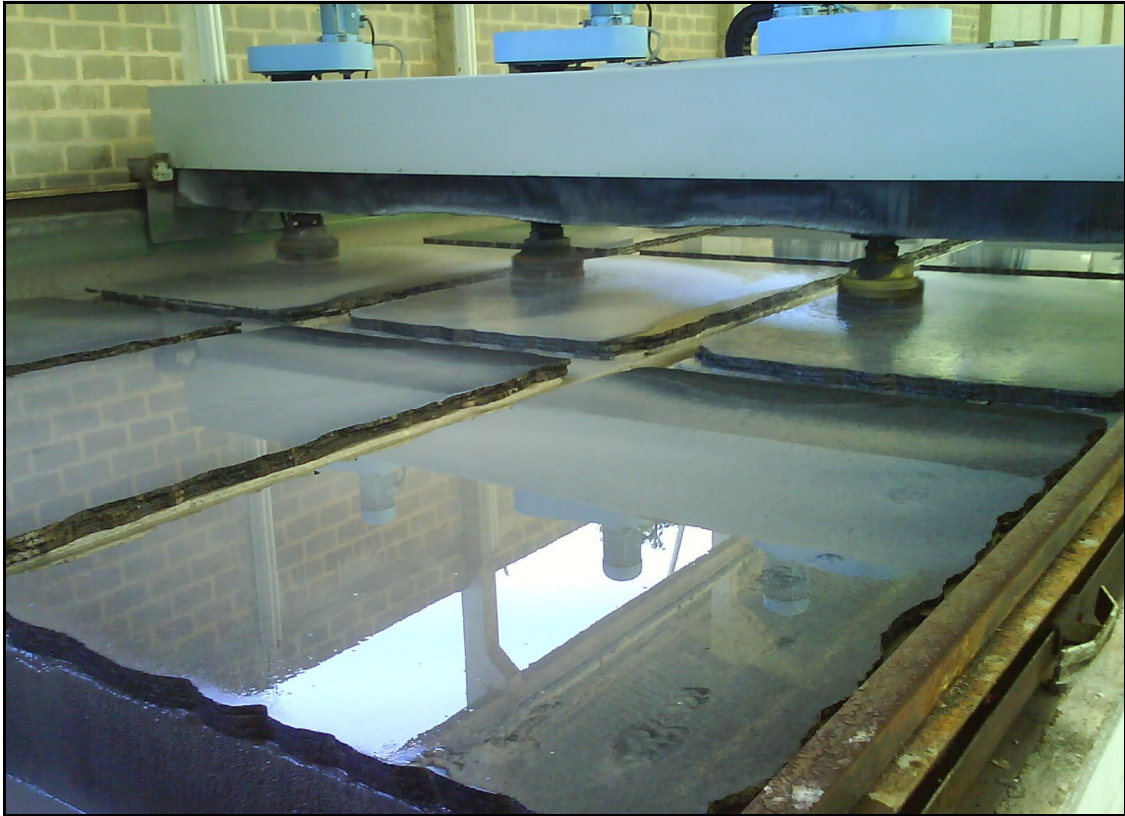
Figura 15 - Processo de polimento realizado em placas semi-acabadas de granito.
