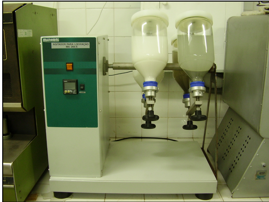
Figura 28 - Ensaio e lixiviação conforme NBR 100.005:2004 ABNT
