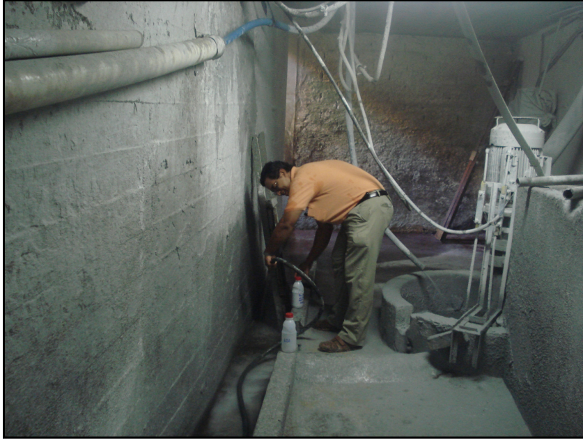
Figura 19 - Preparo para a amostragem a ser realizada na espurga de cada tear de forma segregada.
