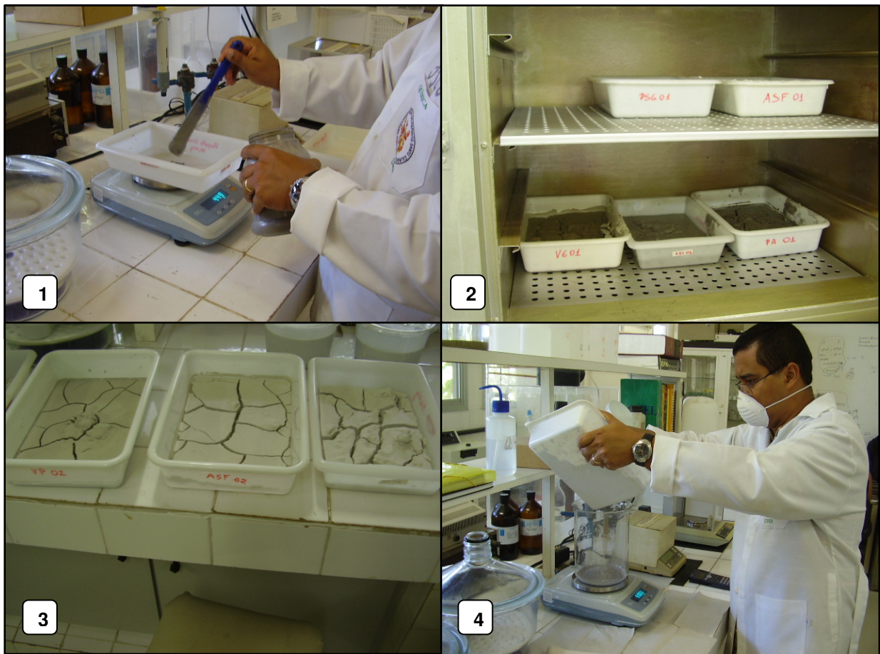
Figura 26- Em 1, preparo de amostra para a secagem a 42 °C em estufa; em 2, amostras em secagem pré-solubilização, em bandejas plásticas, a 42 °C; em 3, resíduos secos, para a determinação do teor de umidade preliminar ao ensaio de solubilização; em 4, pesagem de alíquota de 250g para ensaio de solubilização, segundo norma NBR 10006:2004.
