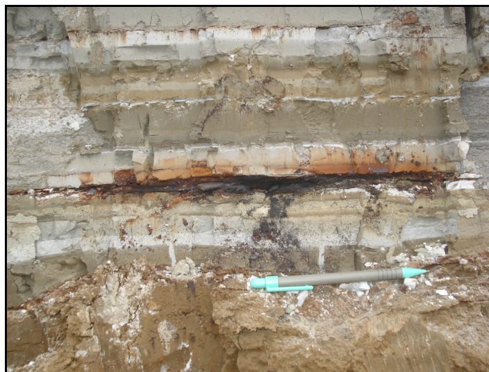
Figura 20 – Perfil de pilha residual em um leito de secagem. A heterogeneidade é flagrante (estratificação); existem focos de concentração de cal extinta e de ferro em oxidação.
