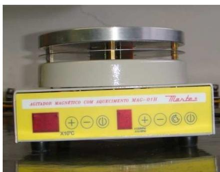
**FIGURA 3.10 – AGITADOR MAGNÉTICO.**
