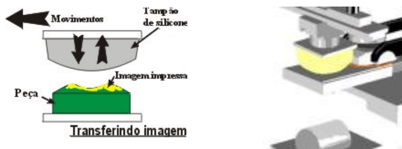
Figura 5.4. Diagrama esquemático do processo de tampografia.
