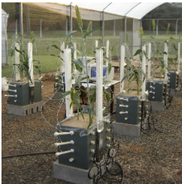
Figura 7 – Posicionamento dos tensiômetros e guias de ondas do TDR nos lisímetros
