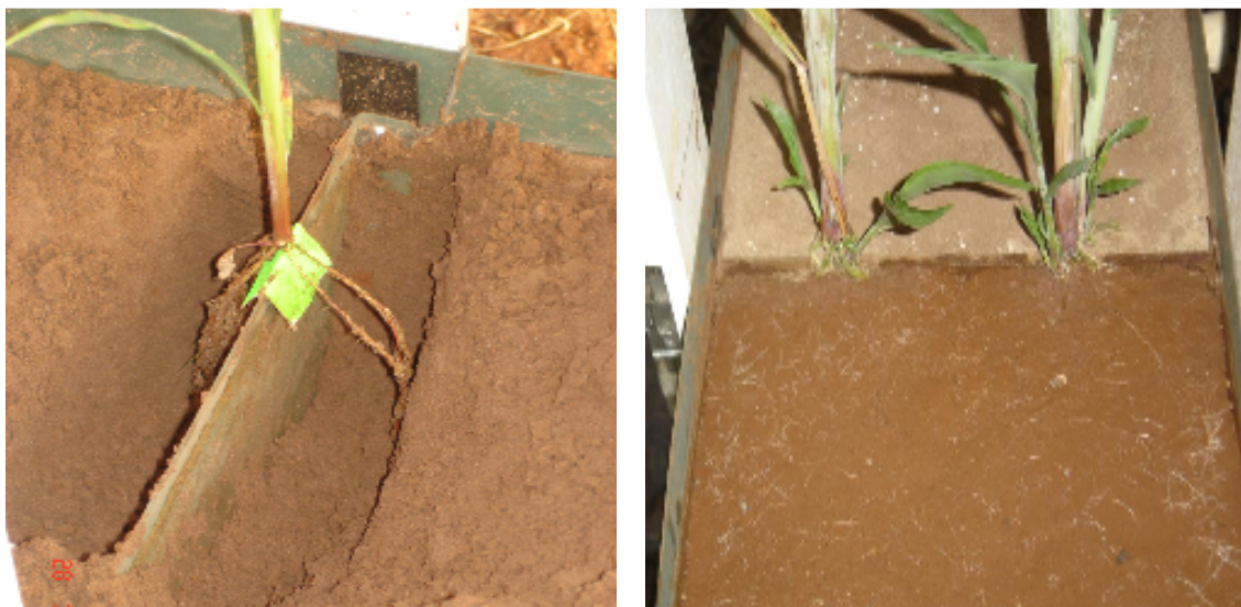
Figura 2 – Posição da planta e divisão do sistema radicular nos compartimentos do lisímetro (esquerda) no momento do transplante e (direita) algumas semanas depois
