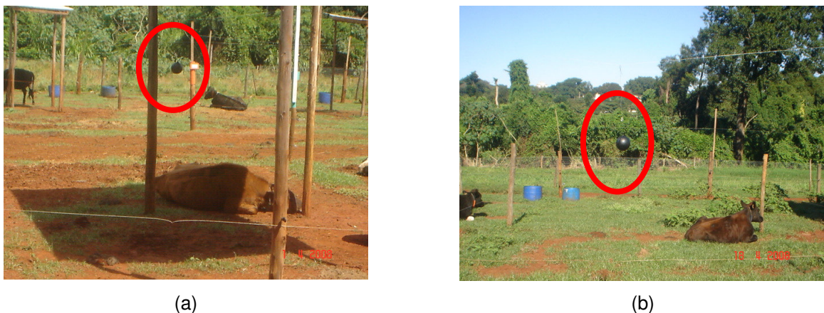
Figura 8 – (a) - Posicionamento dos globos negros a sombra; (b) - posicionamento dos globos negros ao sol (trat. 1)
