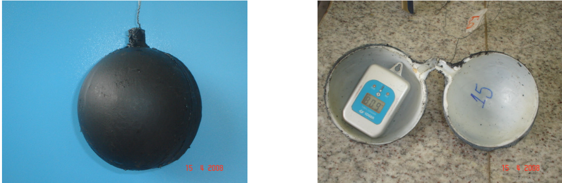
Figura 7 – Sensor acoplado a um minidatalogger “ALPAX” para coleta de temperatura de globo °C
