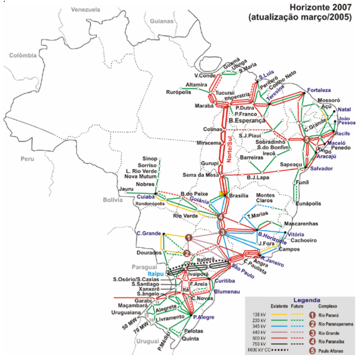
Figura 5- Mapa eletrogeográfico do Sistema Elétrico Interligado Brasileiro - 2005 Fonte: ONS, 2005
