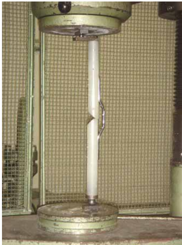
FIGURA 4 – Corpo de prova de poliamida com a placa-onda montada para teste mecânico na Máquina Universal de Ensaio Mecânico tipo ZD-100-PU.
