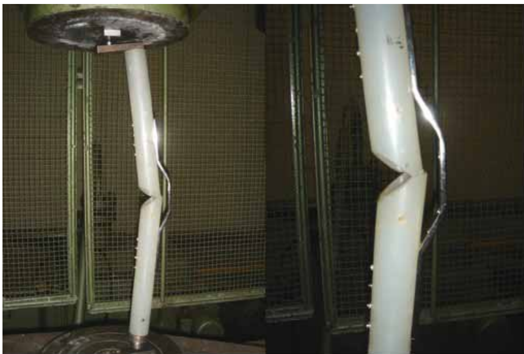
FIGURA 6 – Peça montada na Máquina Universal de Ensaio Mecânico ZD-100-PU. Final da aplicação da carga pela máquina, momento de medida da carga máxima suportada.
