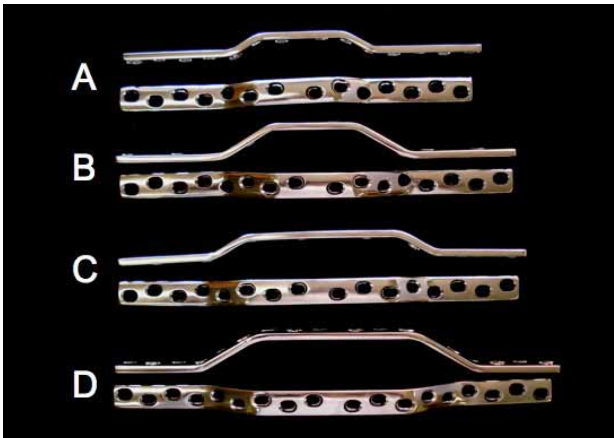
FIGURA 1 – Fotografia das quatro moldagens da placa-onda (vista lateral e antero-posterior). A – placa-onda curta-baixa (CB) com quatro furos de comprimento e 10 mm de altura, B – placa-onda curta-alta (CA) com quatro furos de comprimento e 20 mm de altura, C – placa-onda longa-baixa (LB) com seis furos de comprimento e 10 mm de altura e D – placa-onda longa-alta (LA) com seis furos de comprimento e 20 mm de altura.
