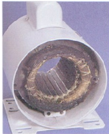
Figura 40 Queima na Bobina Principal [4]
