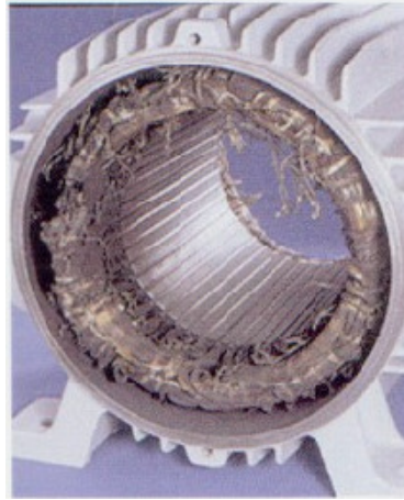
Figura 36 Queima por Sobrecarga [4]
