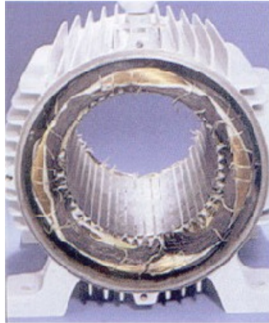
Figura 39 Falta de Fase [4]
