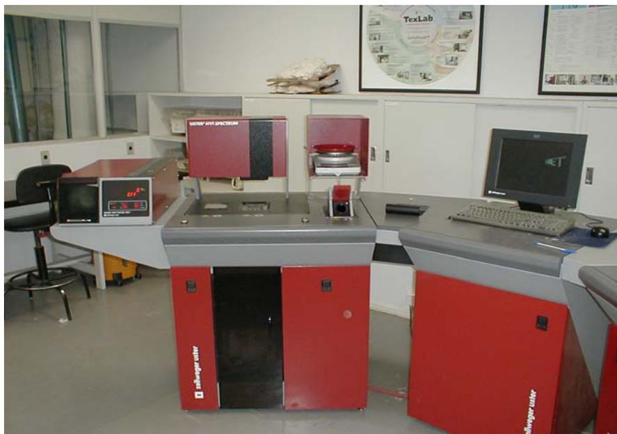
Figura 12 – Equipamento HVI (High Volume Instruments) utilizado para realização das análises de qualidade de fibra conforme padrões internacionais – USDA (United States Department of Agriculture)
