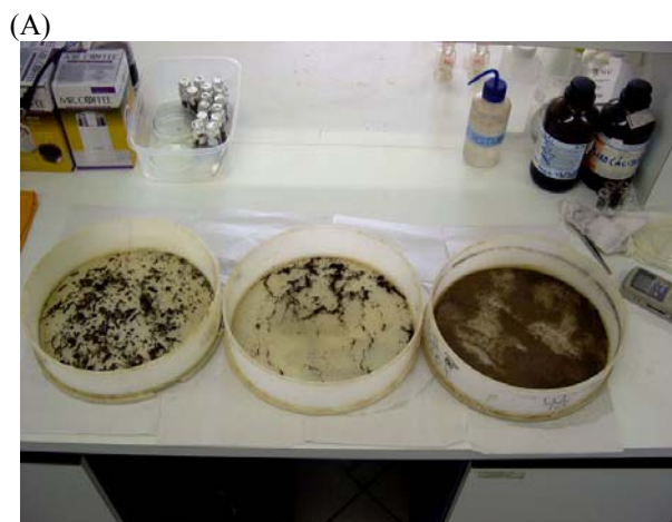
Figura 7 - Separação de raízes com Peneiras de diferentes malhas (2,0, 0,5 e 0,2 mm) (A). Classificação das raízes nas categorias: vivas e mortas (B)
