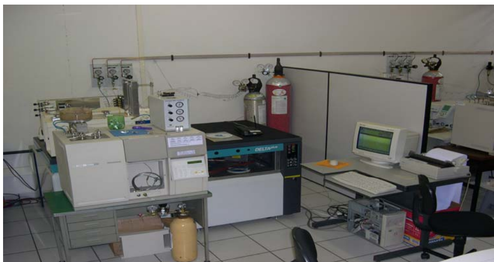
Figura 8 - Conjunto composto por Espectrômetro de massas, analisador elementar e pré-concentrador. Laboratório de Ecologia Isotópica, CENA/USP
