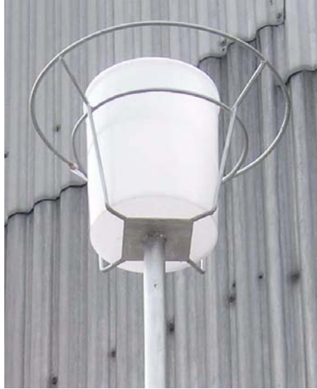
FIGURA 12 – COLETOR DE PARTÍCULAS SEDIMENTÁVEIS E SUPORTE PARA O COLETOR.
