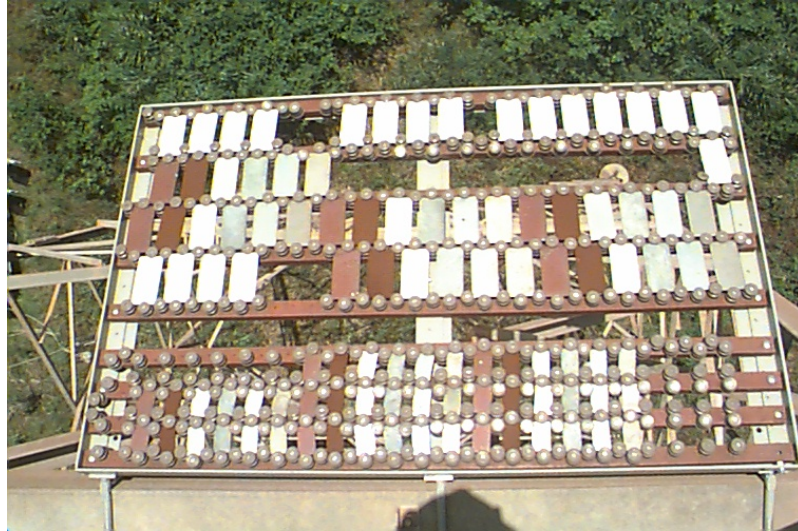
FIGURA 15 – PAINEL DE INTEMPERISMO NATURAL INSTALADO EM 06/05/2004 NA ECA11 C.I. SUL.
