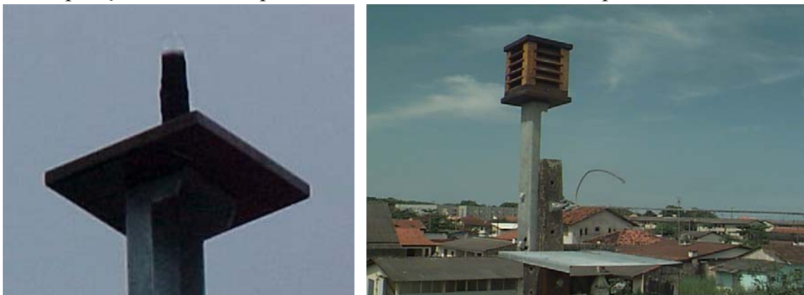
FIGURA 11 – VELA COLETORA DE SULFATOS E SUPORTE DA VELA.
