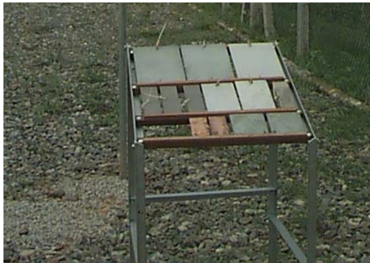
FIGURA 14 – PAINEL DE INTEMPERISMO NATURAL INSTALADO EM 16/05/2002 NA ECA2 RENASCENÇA.
