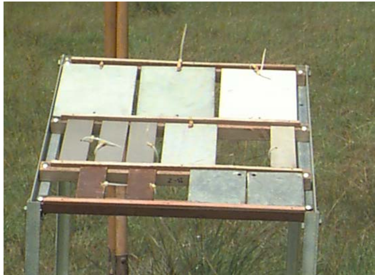
FIGURA 13 – PAINEL DE INTEMPERISMO NATURAL INSTALADO EM 17/05/2002 NA ECA1 C.I. NORTE.
