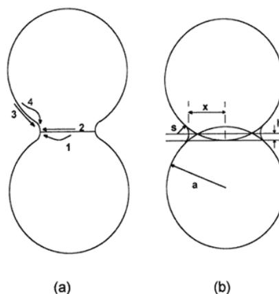
**Figura 3-5 - Sinterização de um sistema de duas partículas esféricas. (a) crescimento de pescoço e mecanismos de difusão (1) do contorno de grão, por volume; (2) do contorno de grão, pelo contorno de grão; (3) da superfície, pela superfície e (4) da superfície, pelo volume. (b) crescimento de pescoço com aproximação de centro e parâmetros representativos:  $a$  é o raio da partícula;  $h$  o parâmetro de aproximação;  $x$  e  $s$ , os raios principais de curvatura do pescoço.**
