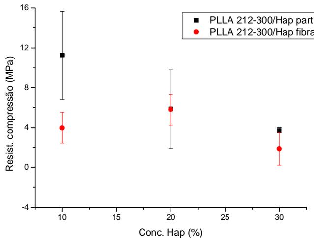
**Figura 5-11 - Gráfico mostrando o comportamento mecânico das amostras com PLLA na faixa granulométrica de 212-300 µm.**
