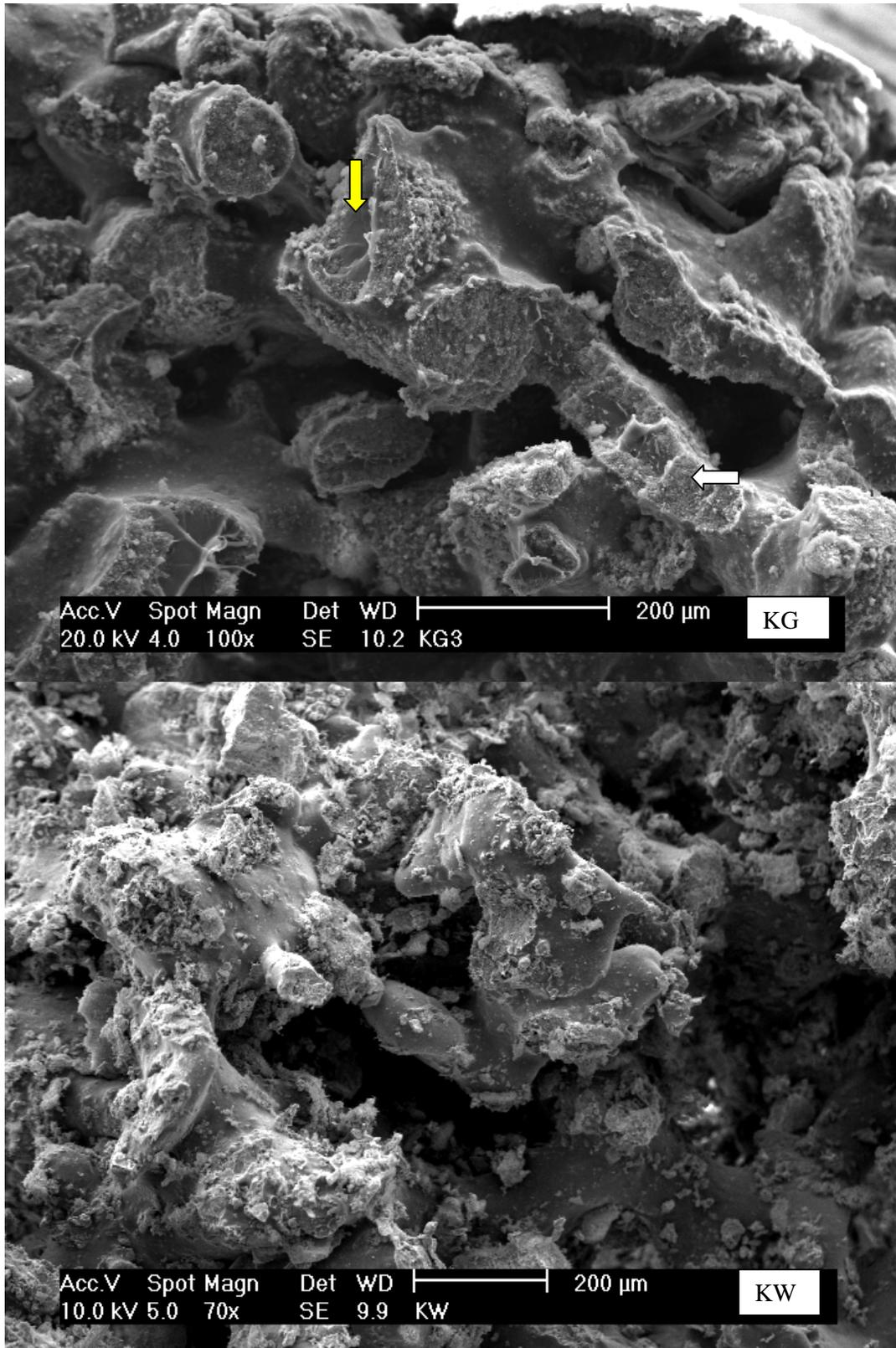
Figura 5-4 Imagem de microscopia eletrônica de varredura das amostras com tamanho de polímero 106-212μm. Amostra KG-30%Hap partículas e KW-30%Hap fibras.
