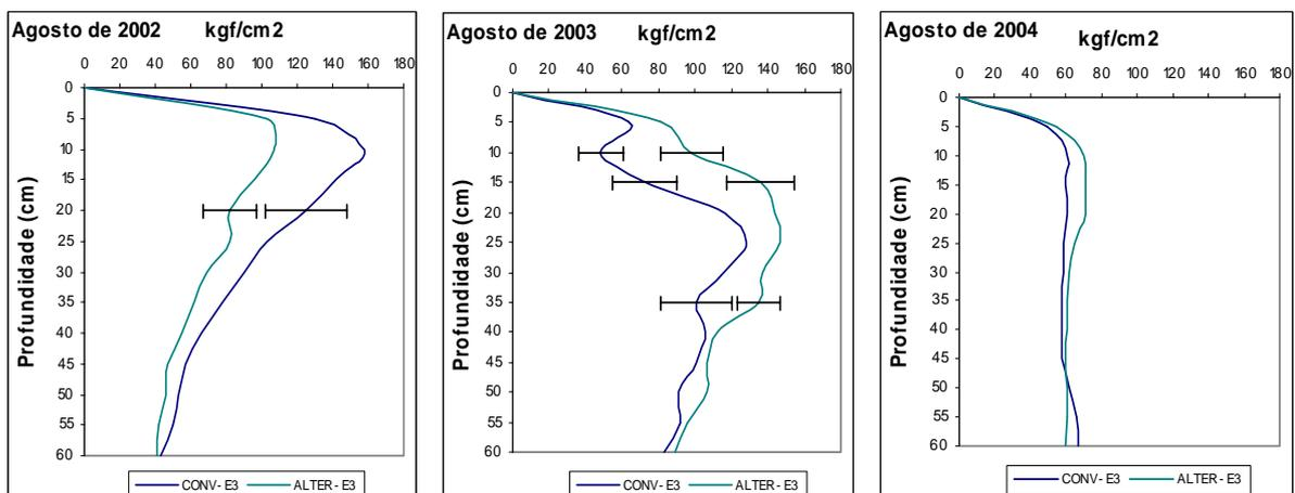
Figura 5 - Resistência do solo à penetração (kgf.cm<sup>-2</sup>) em 3 pontos da faixa da entrelinha (E1, E2 e E3 = 210, 280 e 350 cm a partir do eixo da linha em direção a entrelinha) em dois tratamentos, Convencional e Alternativo, em pomar de tangor 'Murcott' no período de 2002 a 2004. As barras de erro padrão nas curvas dos gráficos indicam significância estatística a 5% pelo teste T para as respectivas profundidades. Médias de 10 repetições
