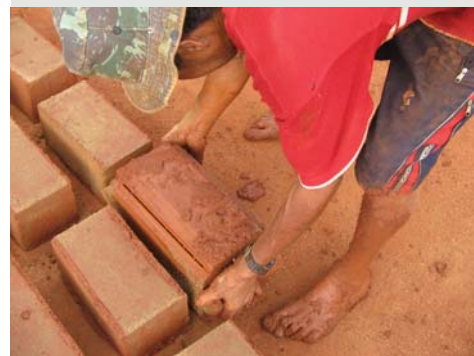
Figura 4.1 Artesão produzindo Blocos de adobe em Tiradentes-MG. Foto do autor, 2006.
