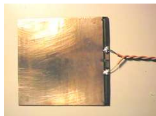
Figura 26: Transdutor de fluxo de calor a gradiente tangencial. (Fonte: GÜTHS et. al. ,1995).
