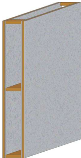
Figura 16: Painel de parede interna.
