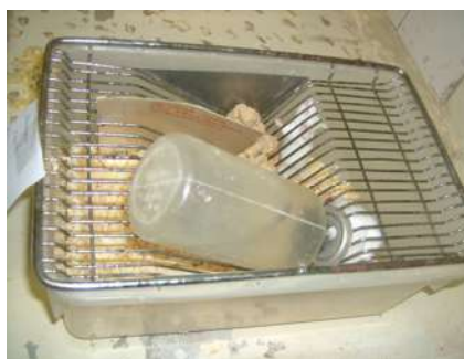
Figura 1A: Ensaios realizados com hamsters , simulação de sua ação nas coberturas com a presença de mantas confeccionadas com embalagens LV.
