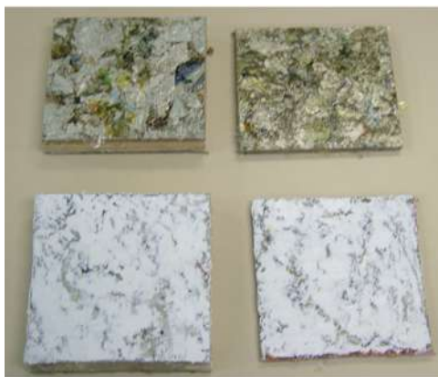
Figura 28: Amostras superiores sem pasta térmica e, inferiores, sem a adição de pasta térmica.
