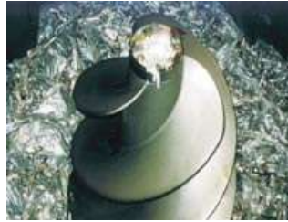
Figura 8: Hidrapulper - Final do processo. Após a desagregação. (Fonte: Tetra Pak, 2005)
