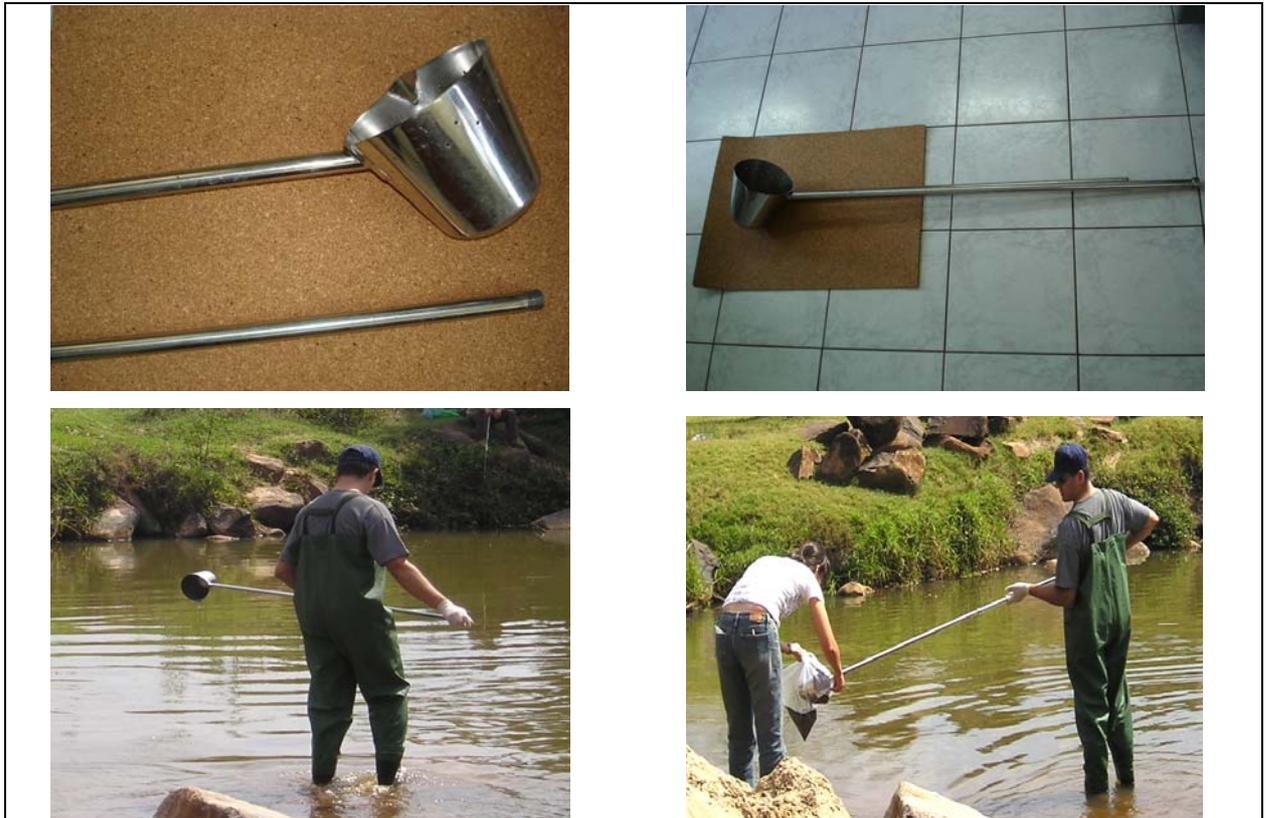
**Figura 4 - Coletor de sedimento e procedimento de coleta**
