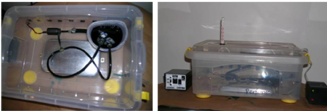
FIGURA 7 - Incubadora com controle de temperatura a 37°C
