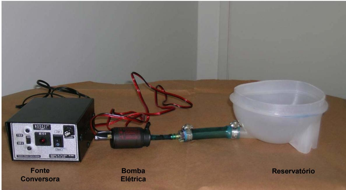
FIGURA 3 - Bomba de Fluxo contínuo sem as mangueiras de irrigação
