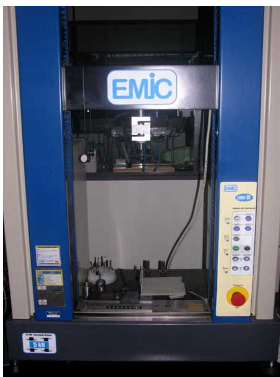
Figura 6 - Máquina de ensaio utilizada na mensuração da força dos elásticos.
