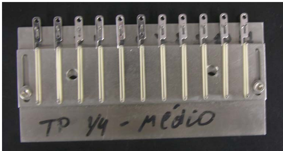
Figura 3 – Modelo de uma placa com identificação do fabricante e elásticos classificados e numerados.
