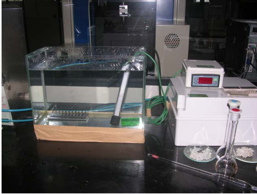
Figura 4 – Tanque com os elásticos submersos em saliva artificial.
