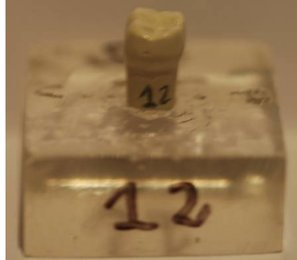
Figura 13 - Exemplo de base de resina acrílica e identificação do corpo de prova
