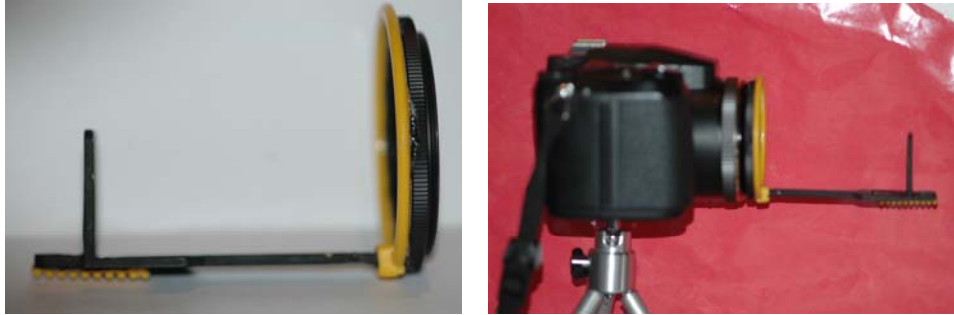
Figura 28 - Anel rosqueável fixado ao posicionador radiográfico e o paralelismo entre a lente da câmera fotográfica e o dispositivo fotográfico
