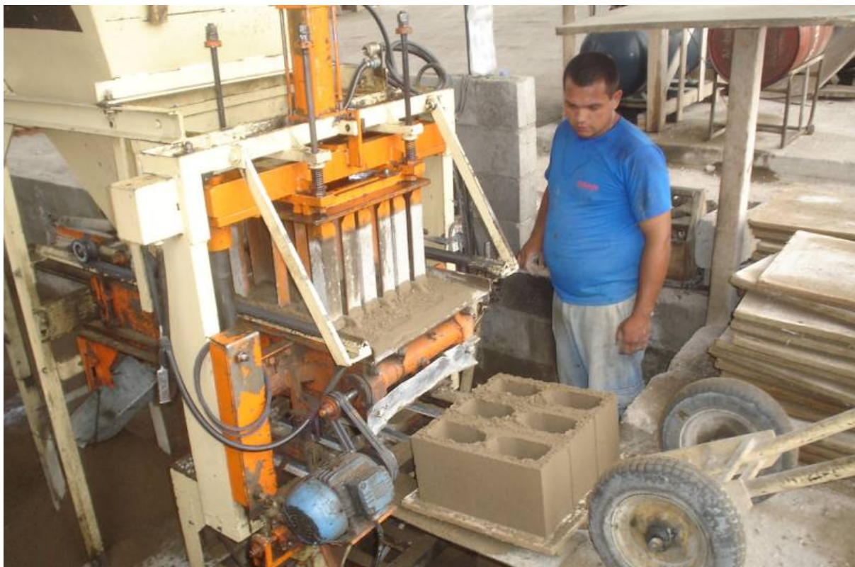
FIGURA 15 – Fibro-prensa semi-automática TBS SUL
