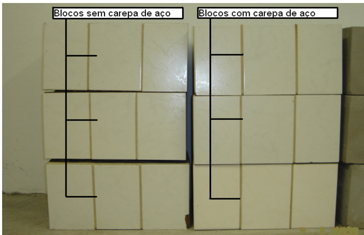
FIGURA 44 – Blocos com e sem carepa de aço com revestimento cerâmico
