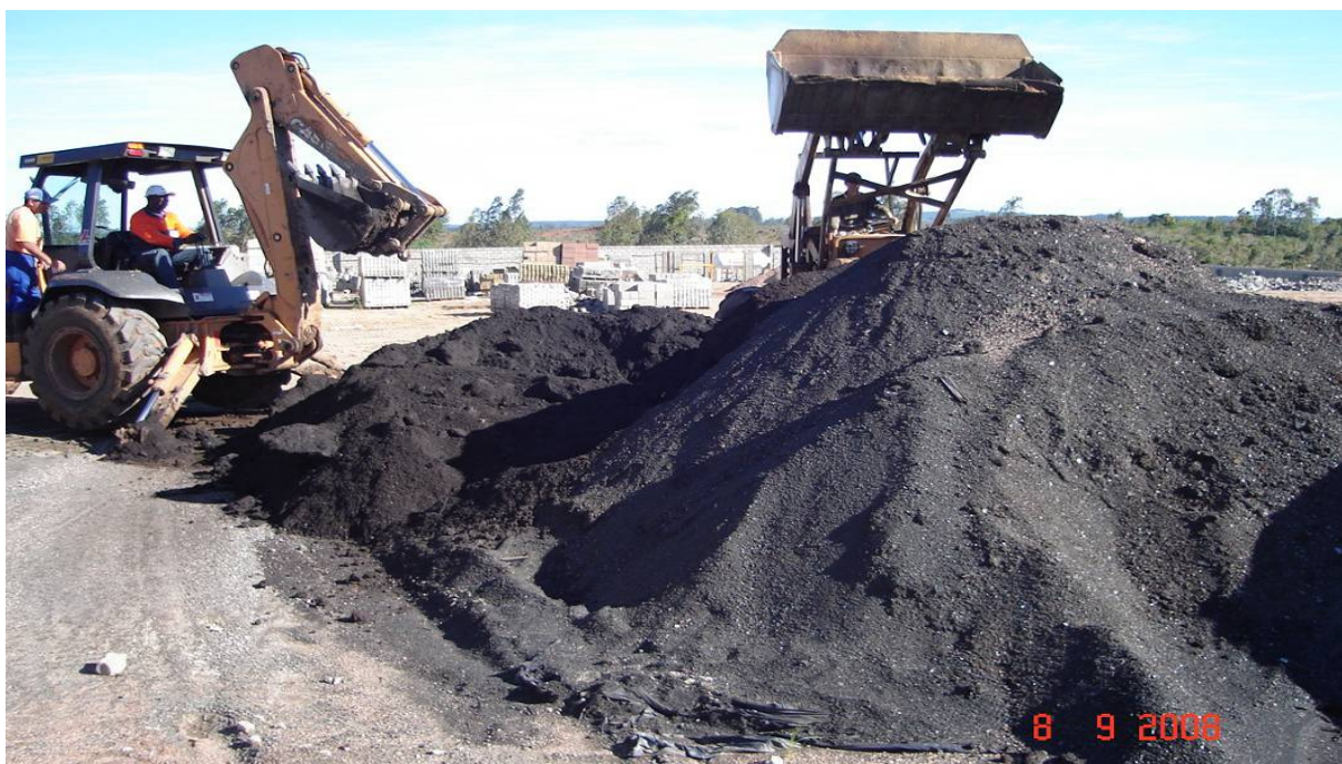
FIGURA 06 – Carepa de aço depositada no pátio da empresa TBS Sul
