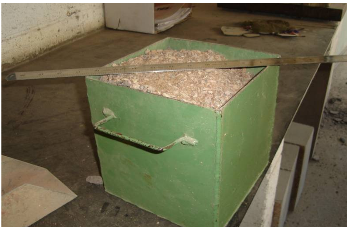
FIGURA 20 – Determinação da massa unitária do pedrisco
