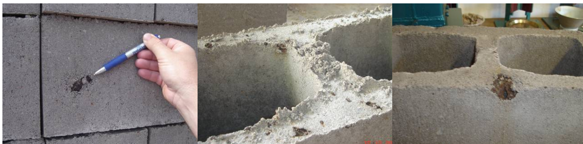
FIGURA 47 – Saliências causadas por aglomerados de carepa de aço
