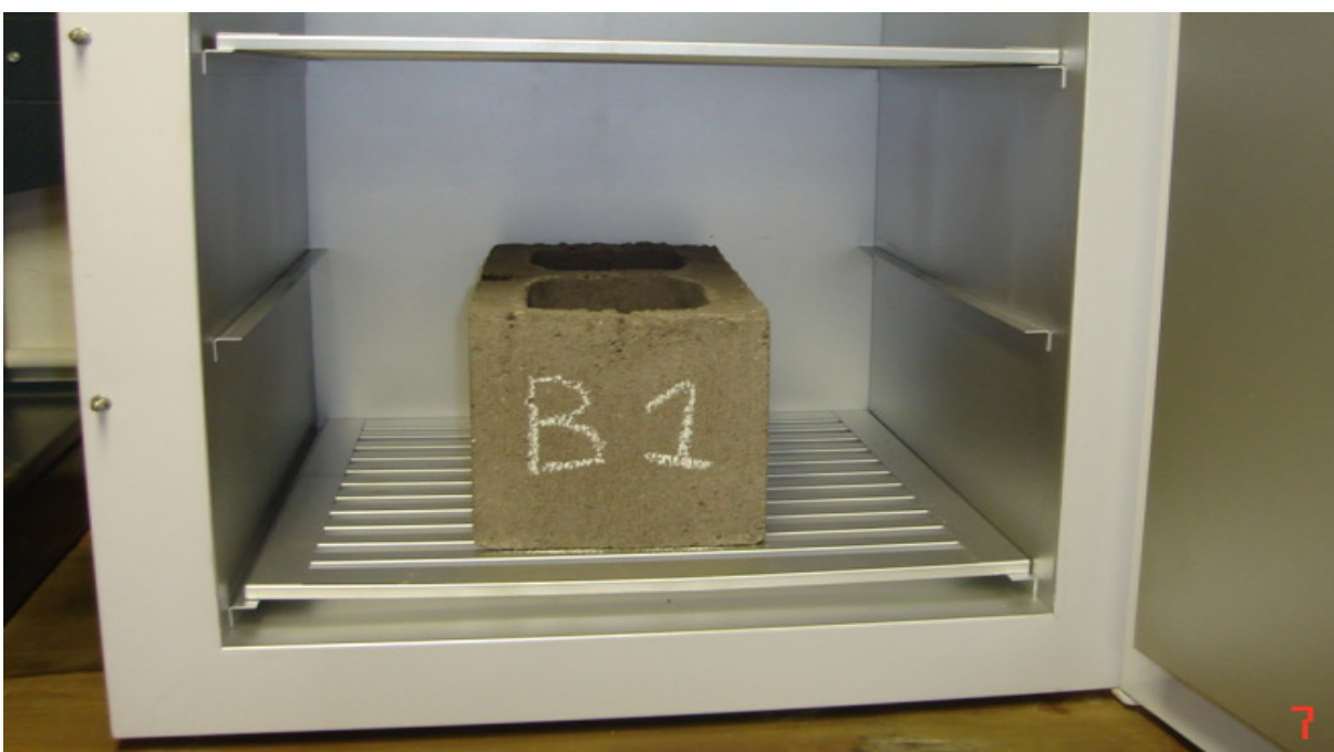
FIGURA 27 – Blocos na estufa determinação da absorção
