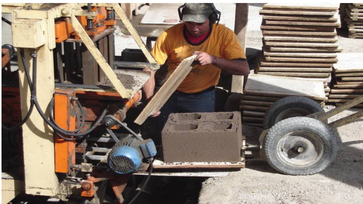
FIGURA 23 – Fibro-prensa semi-automática TBS SUL
