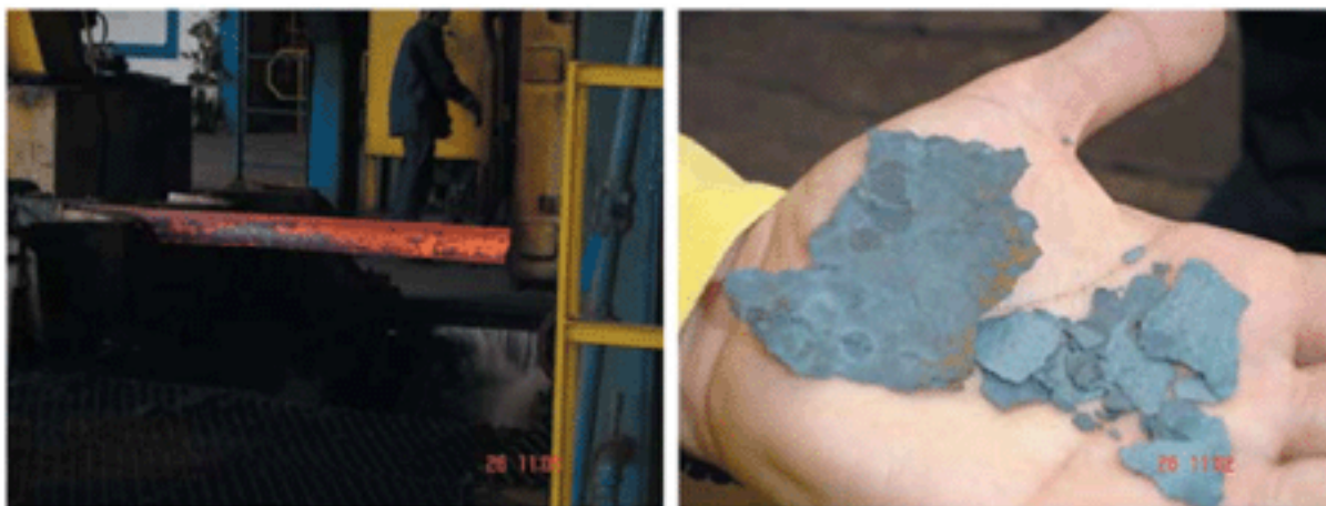
FIGURA 07 – Carepa de aço na superfície do tarugo de aço (esquerda) e carepa de aço eliminada pelo processo (direita)
