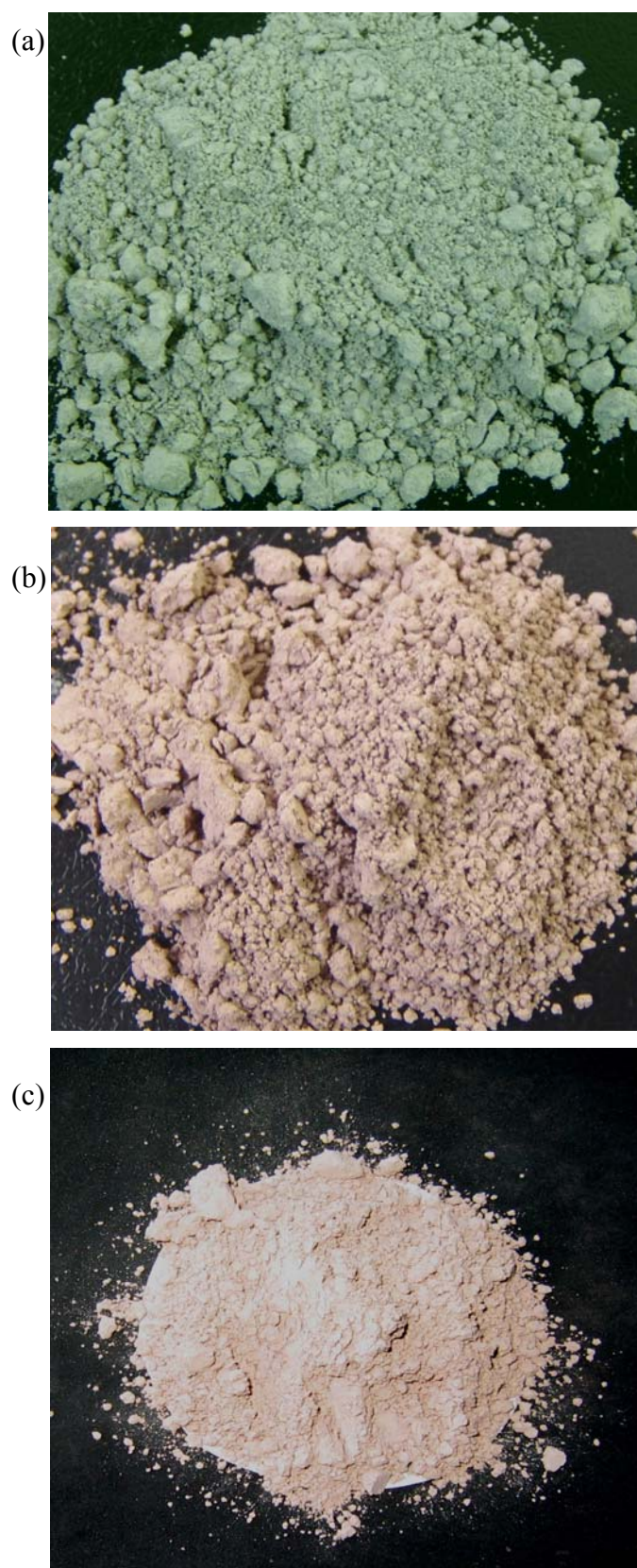
Figura 21 – Fotografias de amostras dos pigmentos com as estruturas de mulita, (a) mulita/ \text{Cr}_2\text{O}_3 , (b) mulita/ \text{Fe}_2\text{O}_3 e (c) mulita/ \text{MnO}_2 – calcinados a 1450^\circ\text{C} por 3h.
