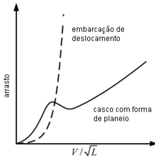
Figura 2.4: Comparação de resistência ao avanço entre um casco de deslocamento e uma embarcação de planeio.
