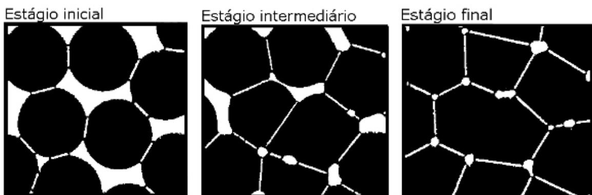
Figura 2.25 – Desenho esquemático representando os estágios de sinterização. Adaptado de German [13] por Pavanati [29].
