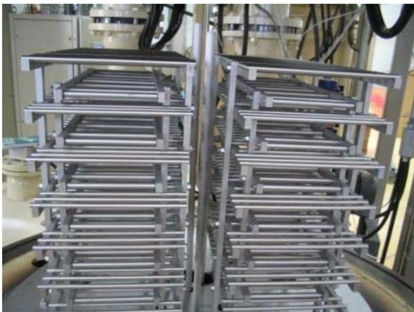
Figura 4.37 - Detalhe da construção do conjunto cátodo-anodo do reator industrial da Steelinject [68].
