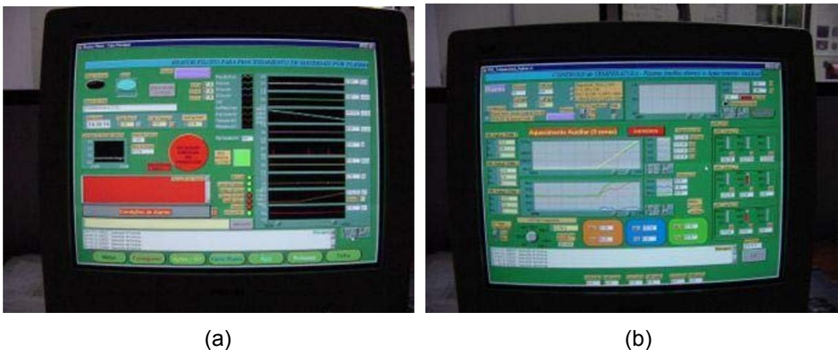
Figura 3.18 - Telas do *Software* de controle. (a) Supervisão geral das variáveis. (b) Monitoramento da potência do aquecimento auxiliar resistivo.
