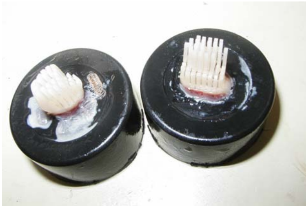
Figura 18: Amostras cortadas em vários filetes, prontas para o teste de microtração. Observe que alguns filetes tiveram a porção de resina fraturada durante o procedimento de corte.
