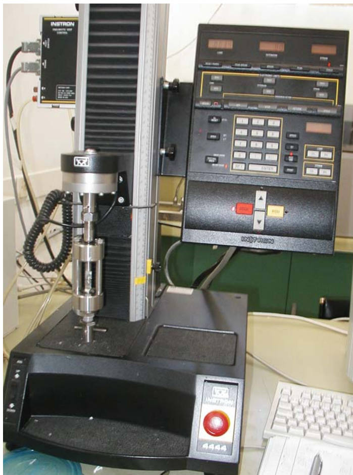
Figura 19: Máquina de ensaios, Instron 4444, com a amostra posicionada para ser submetida ao teste.
