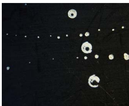
Figura 15: Marcas deixadas pelo feixe do laser em várias posições após incidir no espelho côncavo. As marcas maiores apresentam o feixe com o característico orifício no centro, em forma de um donut . Perto da região do foco, o feixe fica com uma distribuição de energia mais homogênea, fechando o orifício no centro.
