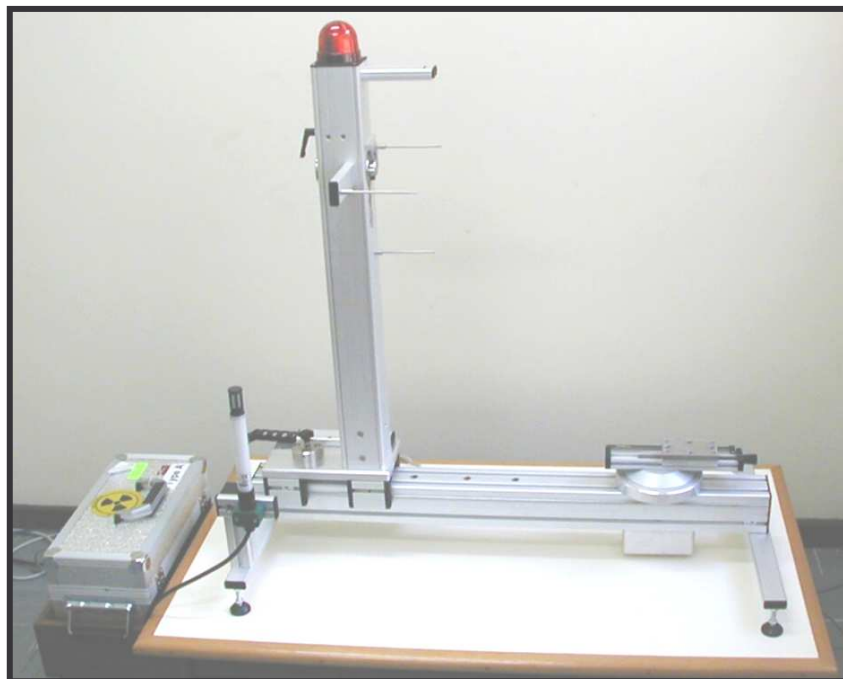
FIGURA 2 – Sistema padrão secundário beta BSS2.
