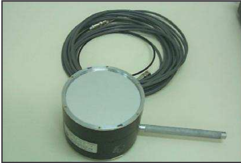
FIGURA 9 – Câmara de ionização, modelo 2575 de 600 cm 3 , usada nas medidas de abertura e fechamento do obturador e reprodutibilidade de geometria das fontes.
