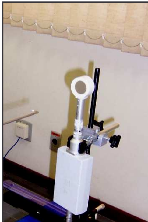
FIGURA 10 – Câmara de ionização Radcal 10X5-6M de 6 cm 3 .
