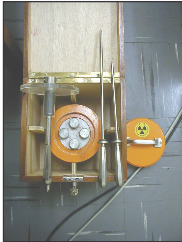
a) b) FIGUR A 7 - a) Sist em a pad rão sec und ário bet a BS S1. b) Rec ipie nte blin dad
