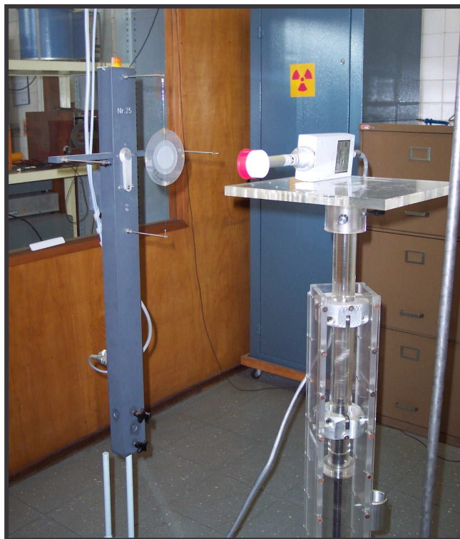
FIGURA 30 – Posicionamento da câmara de ionização para medidas comparativas, no sistema BSS1 no IPEN.
