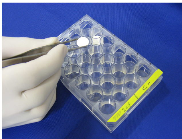
Figura 4: Colocação dos arcabouços de CFC na placa de poliestireno de 24 poços.
