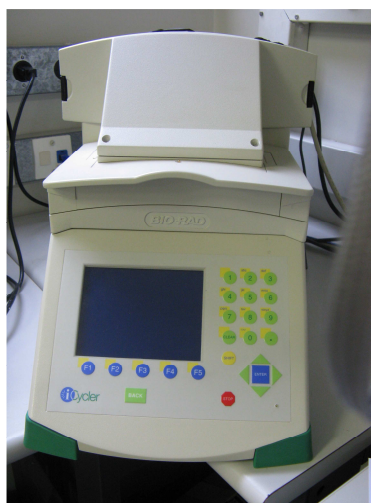
Figura 6: Aparelho iCYCLER (BIO-RAD) para amplificação do cDNA do QT-PCR.
