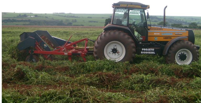
Figura 3. Conjunto trator x arrancador-invertedor utilizado no arranquio.
