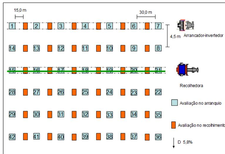
Figura 5. Croqui da malha regular utilizada para as avaliações.
