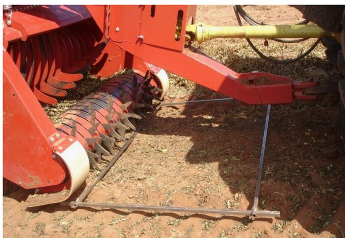
Figura 10. Posicionamento da armação para a coleta das perdas na plataforma.
