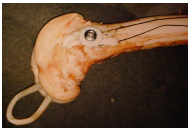
Figura 2. Sistema de fixação evidenciando as extremidades livres fixadas pela Arruela Denteada de Polietileno e a alça permanecendo livre para ser presa ao dispositivo de tração
