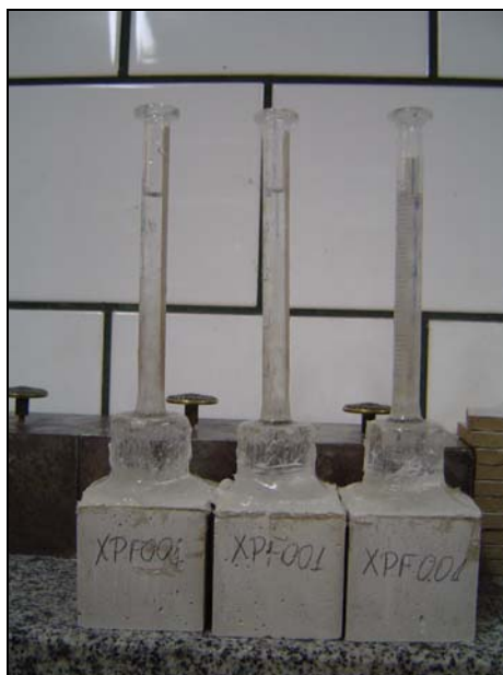
Figura 5.21 – Detalhe da finalização do teste de permeabilidade aos 240 minutos, com a fixação da coluna de vidro sobre os CP's.
