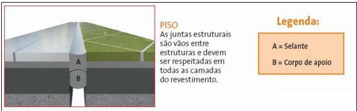
Figura 4.10 – Junta estrutural (O Guia Weber Digital, 2008)
