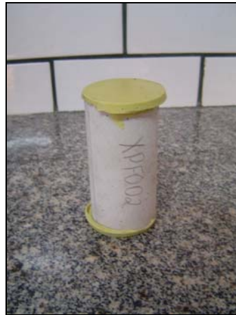
Figura 5.18 – CP desformado e capeado.
