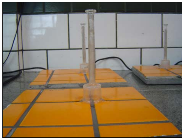
a) Fixação do cachimbo sobre as placas.
