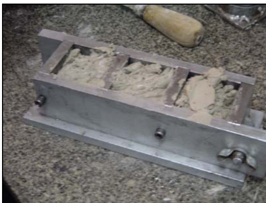
Figura 5.20 - Confeção das fôrmas para realização do ensaio de permeabilidade aos 240 minutos.
