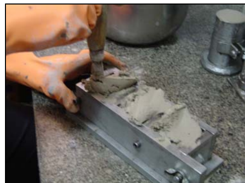
Figura 5.20 - Confeção das fôrmas para realização do ensaio de permeabilidade aos 240 minutos.
