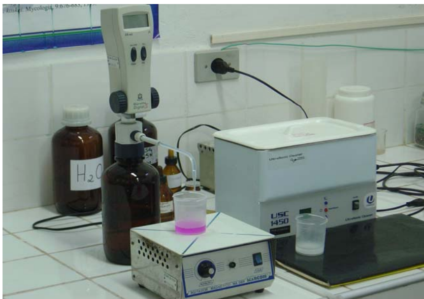
Figura 4 – Frasco com 10 mL de NaOH (0,2 M) e BaCl 2 (saturado) para reação com o CO 2 capturado na presença do indicador fenolftaleína e titulação com HCl (0,1 M)
