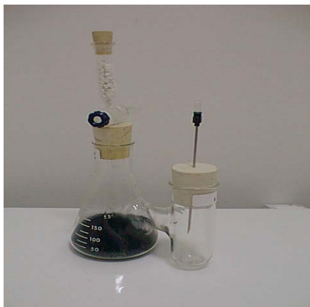
Figura 8 - Frasco de Bartha com solo e armadilha de KOH (0,1 M) para captura do ^{14}\text{CO}_2
