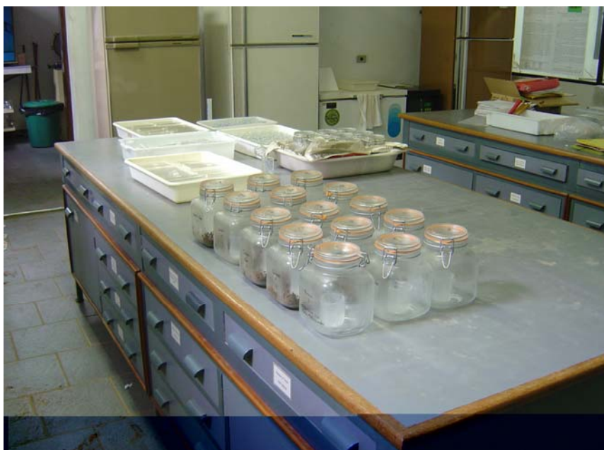
Figura 3 - Ensaio de transformação de carbono em frascos herméticos com armadilha de NaOH para captura de \text{CO}_2
