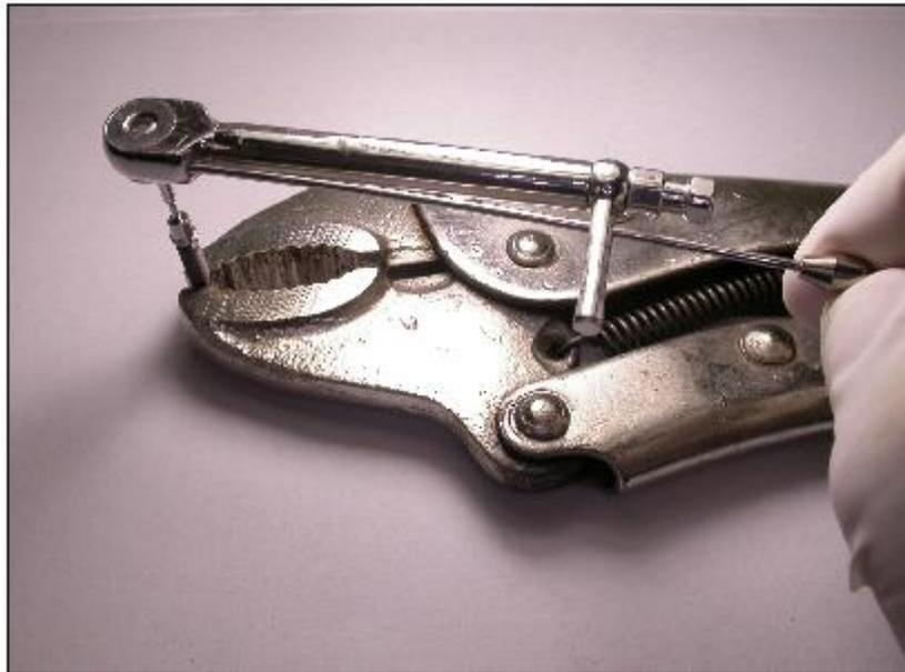
Figura 8 - Fechamento com torquimetro manual (Neodent).
