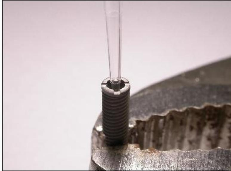
Figura 6 - Inserção perpendicular à base da rosca interna do implante.
