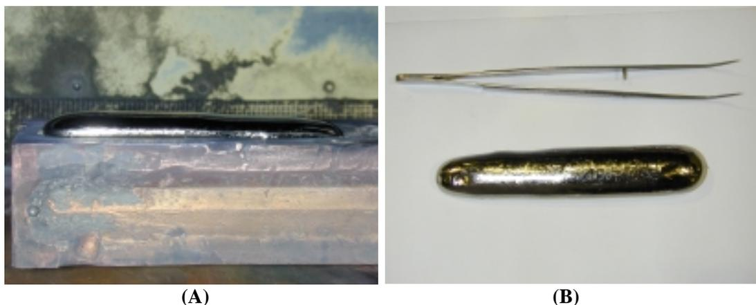
**Figura IV.4** – Lingote fundido: (A) no cadinho depois do resfriamento; (B) fora do forno.
