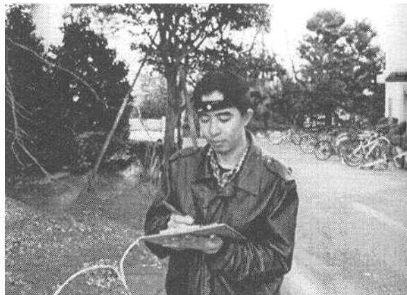
Figura 2-24. Sujeito com um fotômetro (luxímetro) acoplado na região frontal da cabeça. Fonte: Shukuya e Morihana (2000).
