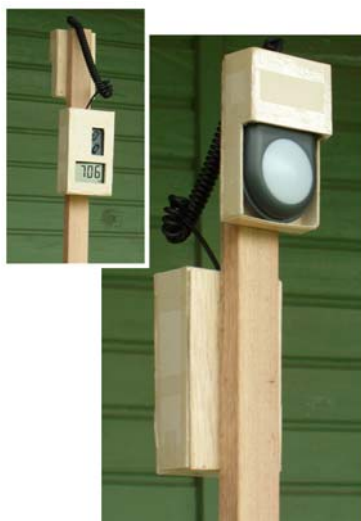
Figuras 3-18. Suporte desenvolvido para medir a quantidade de luz que chega no plano da face do usuário.
