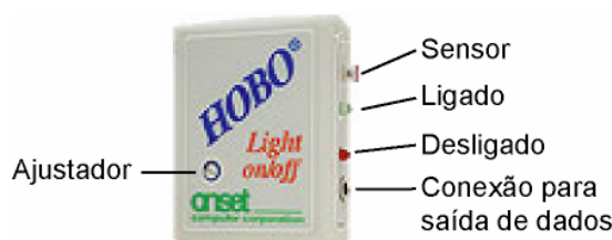
Figura 3-11. Sensor Hobo light on/off , armazena até 2.000 dados.
