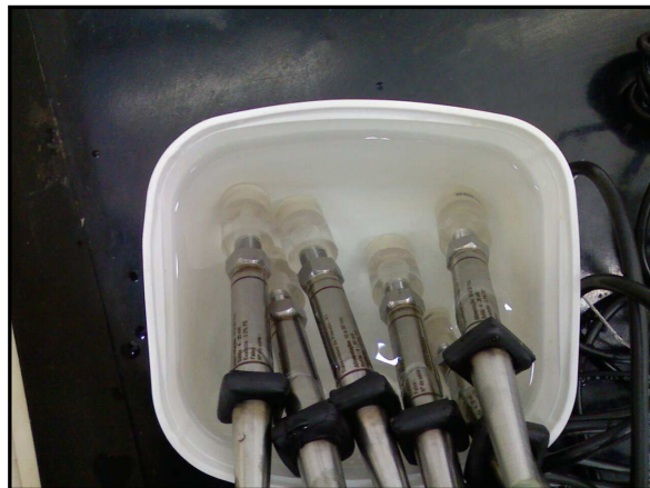
Figura 4.52: Tensiômetros montados na presente pesquisa aguardando instalação no pavimento.
