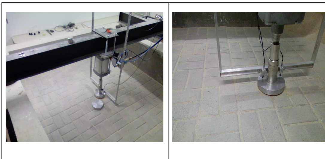
Figura 5.22: Detalhes do ensaio da estrutura do pavimento com revestimento tipo peças pré-moldadas de concreto.
