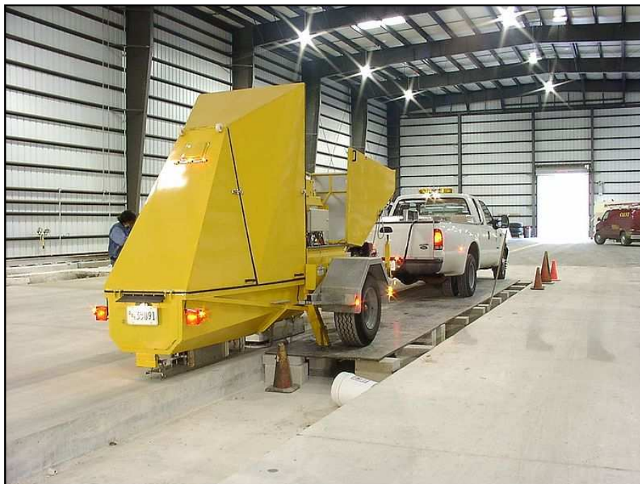
Figura 6.22: Equipamento FWD rebocável, utilizado em avaliação de pavimentos.
