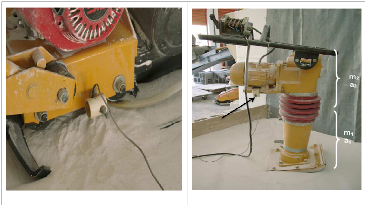
Figura 4.28: Fixação do acelerômetro na base da placa vibratória e no topo do soquete vibratório. (SARAMAGO, 2002)
