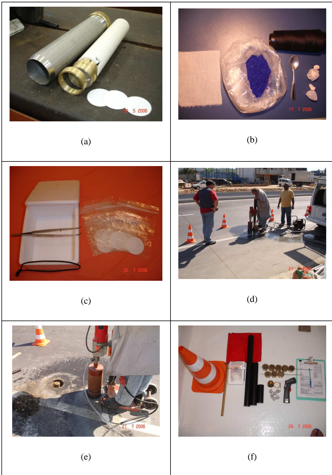
Figura 4.65: Detalhes do dispositivo de medição de sucção em campo.
