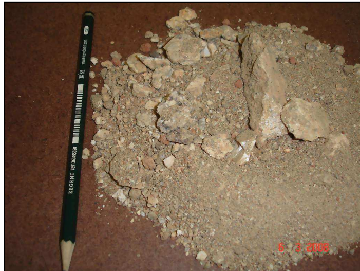
Figura 4.7: Aparência física do material empregado como subleito nesta pesquisa.
