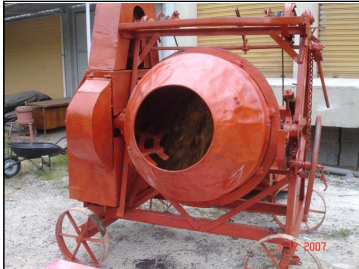
Figura 4.26: Betoneira de 520 litros utilizada para homogeneização da umidade do material na umidade ótima.
