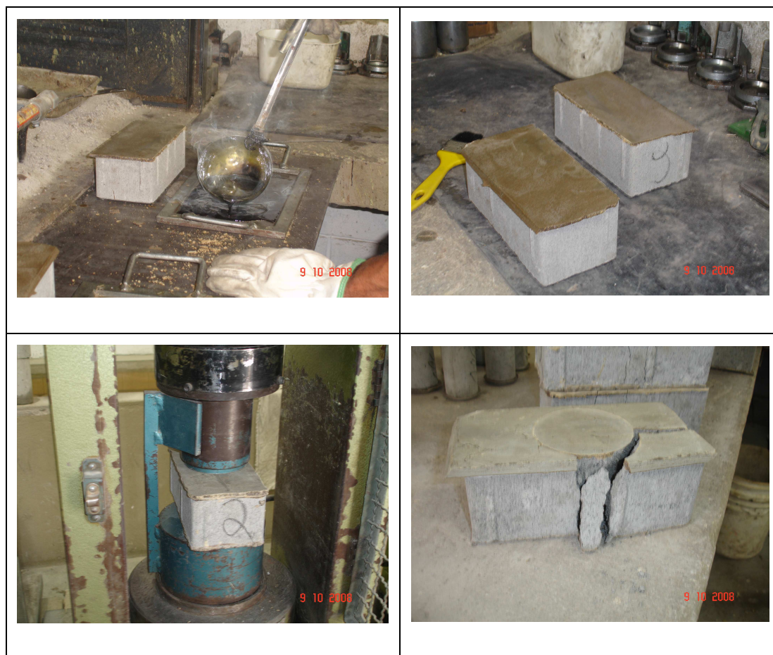
Figura 4.31: Detalhes do ensaio de compressão axial nas peças de concreto pré-moldadas.
