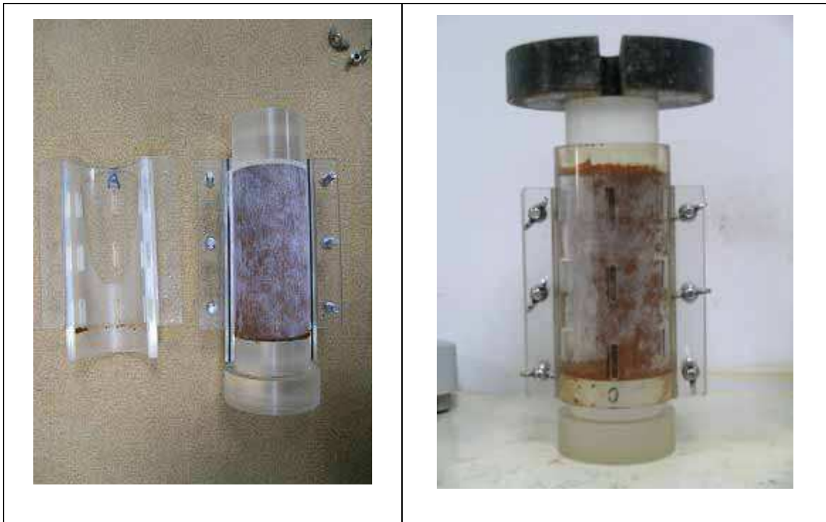
Figura 2.1: Dispositivo para saturação de corpo-de-prova, YANG et al. (2005).
