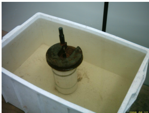
Figura 4.47: Aumento do teor de umidade do corpo-de-prova por imersão em tanque d'água.
