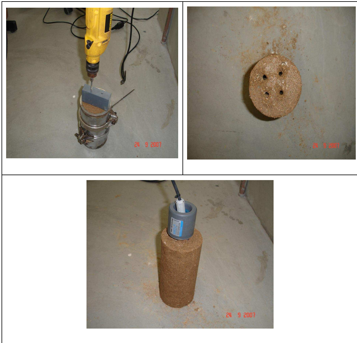
Figura 4.45: Etapa de preparação da furação que receberá as hastes da sonda do TDR.
