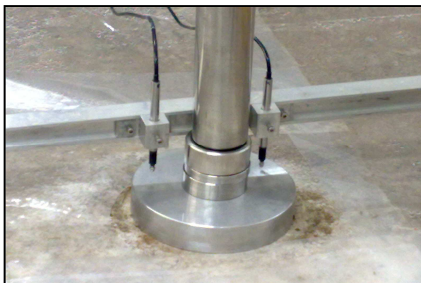
Figura 5.8: Instalação dos LVDTs sobre a placa circular rígida para obtenção do deslocamento elástico vertical total no topo do pavimento estudado nesta pesquisa.
