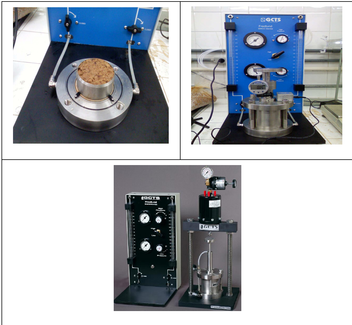
Figura 4.48: Detalhes da acondicionamento da amostra de solo e da célula de pressão do equipamento SWC-150, com e sem o dispositivo de sobrecarga, do Laboratório de Geotecnia – Setor de solos não saturados.
