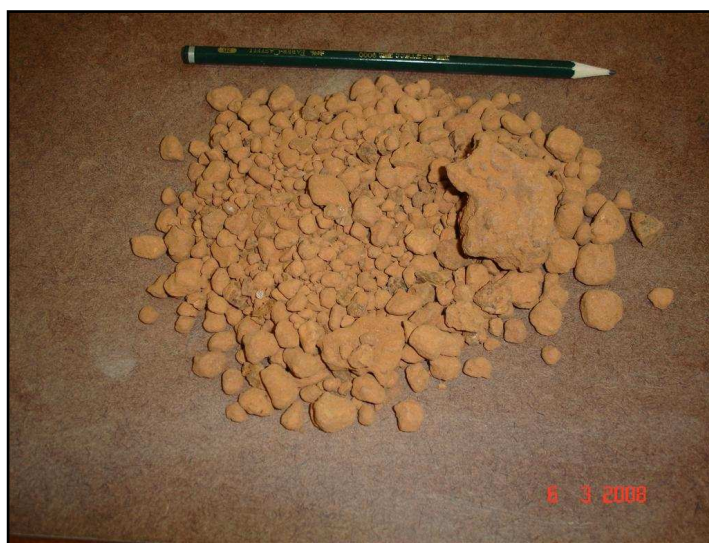
Figura 4.12: Aparência física do material empregado como sub-base nesta tese.
