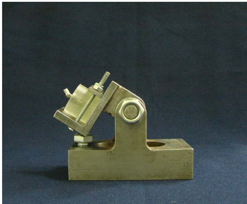
Figura 15 - Conjunto montado mostrando a posição do implante com pilar angulado em 30^\circ para receber a carga a 30^\circ em relação ao pilar
