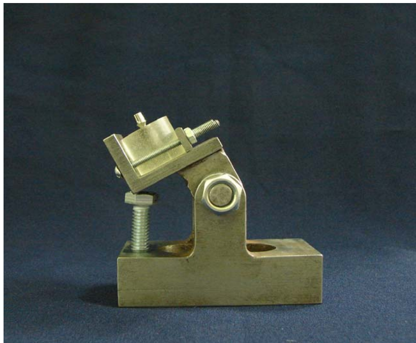
Figura 11 - Conjunto montado mostrando a posição do implante com pilar reto para receber a carga a 30^\circ em relação ao pilar
