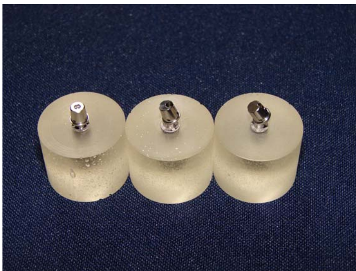
Figura 7 - Implantes com pilar reto, angulado em 17° e angulado em 30°, respectivamente
