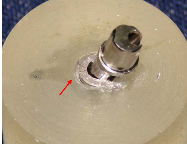
Figura 26 - Leve deslocamento do implante dentro da resina
