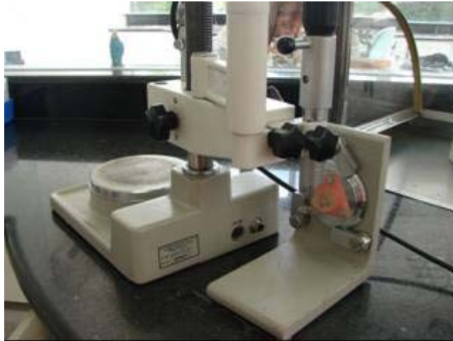
Figura 18 - Fresadora utilizada para corte dos implantes
