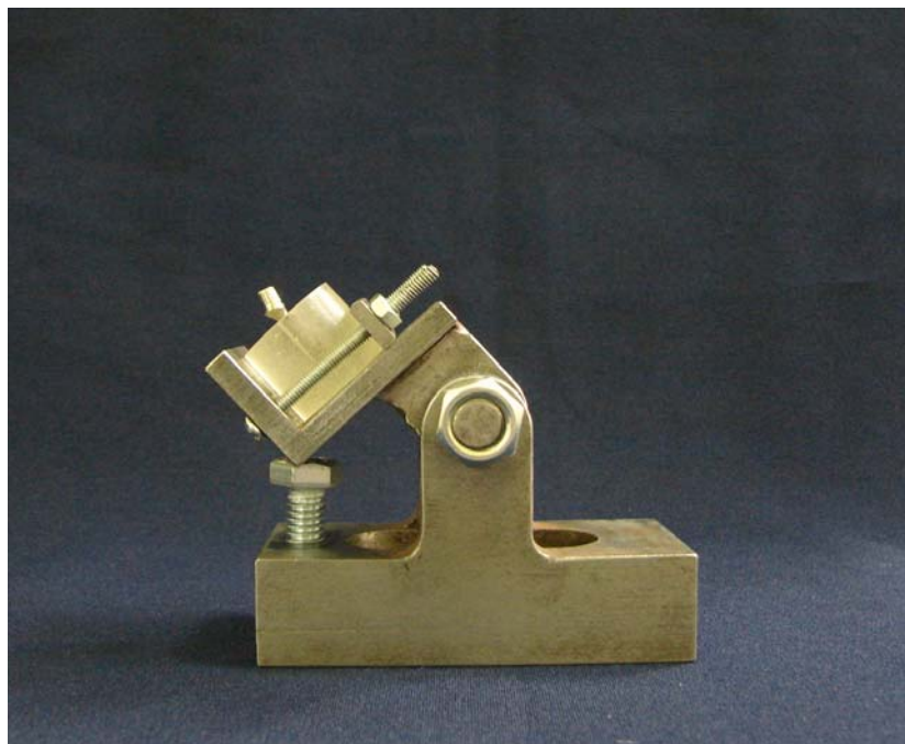
Figura 13 - Conjunto montado mostrando a posição do implante com pilar angulado em 17^\circ para receber a carga a 30^\circ em relação ao pilar
