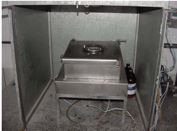
Figura 20 –Equipamento de remoção de ligante por solvente
