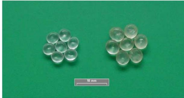
Figura 31 - EVA normal (esquerda) e intumescido após imersão no hexano (direita)
