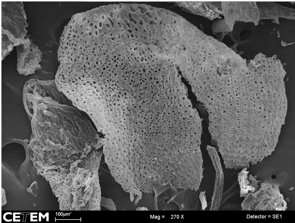
Figura 11: MEV da turfa canadense com aumento de 270 X
