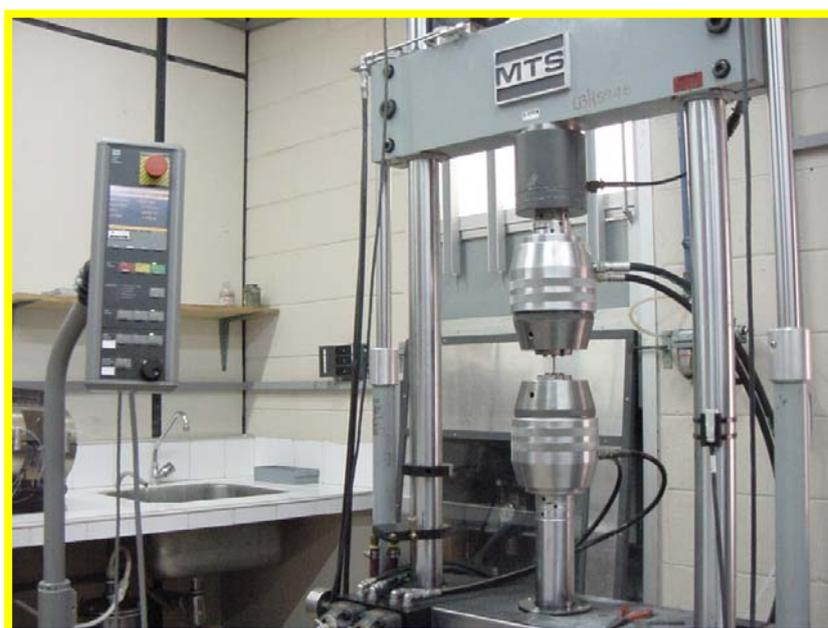
FIGURA 12 – Máquina de ensaio cíclico
