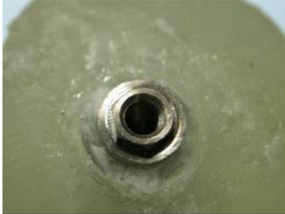
FIGURA 5 - Implante de conexão externo fixado no centro da base de resina
