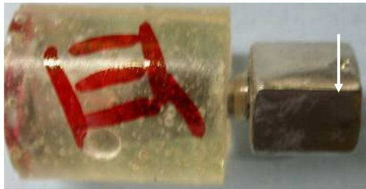
FIGURA 8 - Mostrando perfuração de 1 mm abaixo da superfície da supra-estrutura onde incidirá a força cíclica
