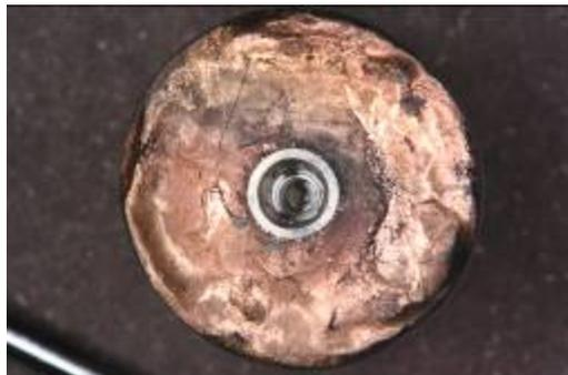
FIGURA 6 - Implante de conexão interno fixado no centro da base de resina
