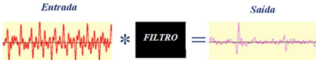
Figura 3.9: Ilustração do processo de Deconvolução Preditiva: é realizada a convolução entre o ruído indesejável e um filtro designado, resultando assim, em um sinal mais coerente.
