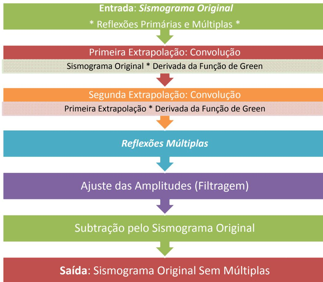
Figura 5.5: Fluxograma do método de remoção de múltiplas utilizando extrapolação de campos de onda.
