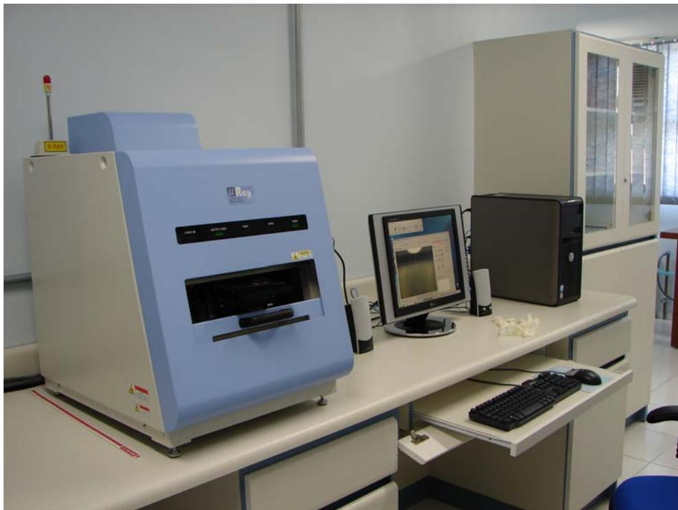
Figura 9 – Aparelho de micro-espectrometria de fluorescência de raios-x por energia dispersiva ( $\mu$ ED-XRF) marca Shimadzu, modelo  $\mu$ EDX-1300.
