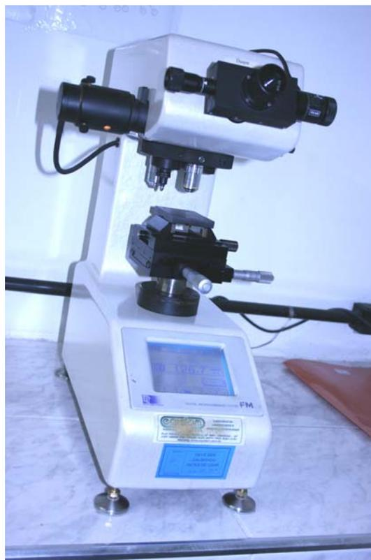
Figura 11 – Microdurômetro de Vicker's (Futuretech Digital Microhardness Tester FM).
