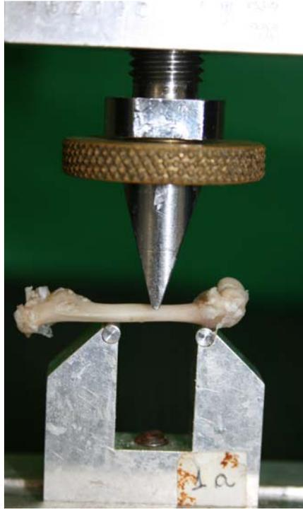
Figura 17 – Fêmur preparado e posicionado para realização do ensaio de flexão em três pontos.
