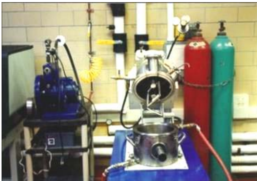
Figura 2.9 - Misturador planetário duplo de laboratório. MARTINS [14].
