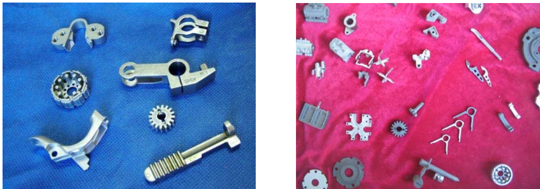
Figura 2.7 - Peças produzidas pelo processo MPI (Cortesia Steelinject - Lupatech).
