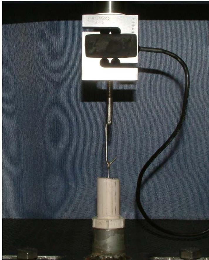
FIGURA 13 – Corpo-de-prova para tração
