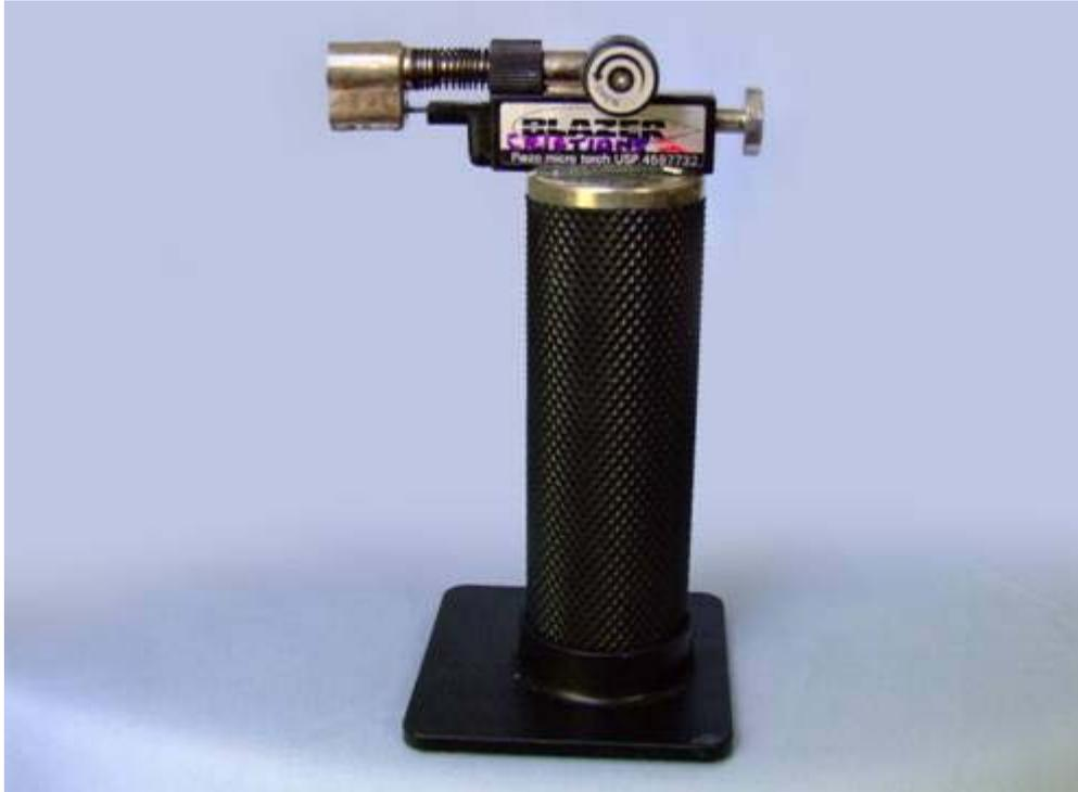
FIGURA 7 – Maçarico mini-flan
