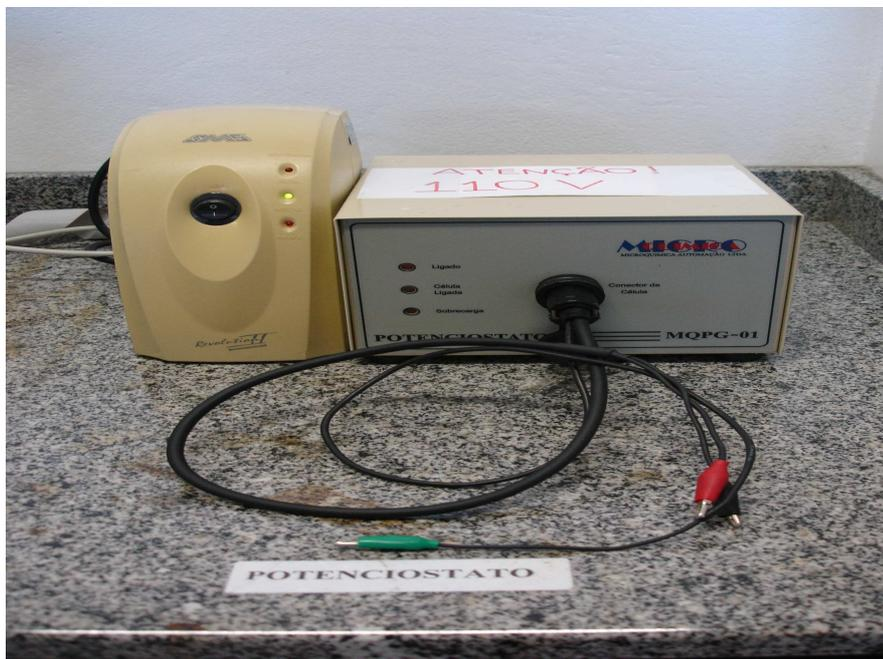
FIGURA 7 - Potenciostato utilizado nos ensaios eletroquímicos
