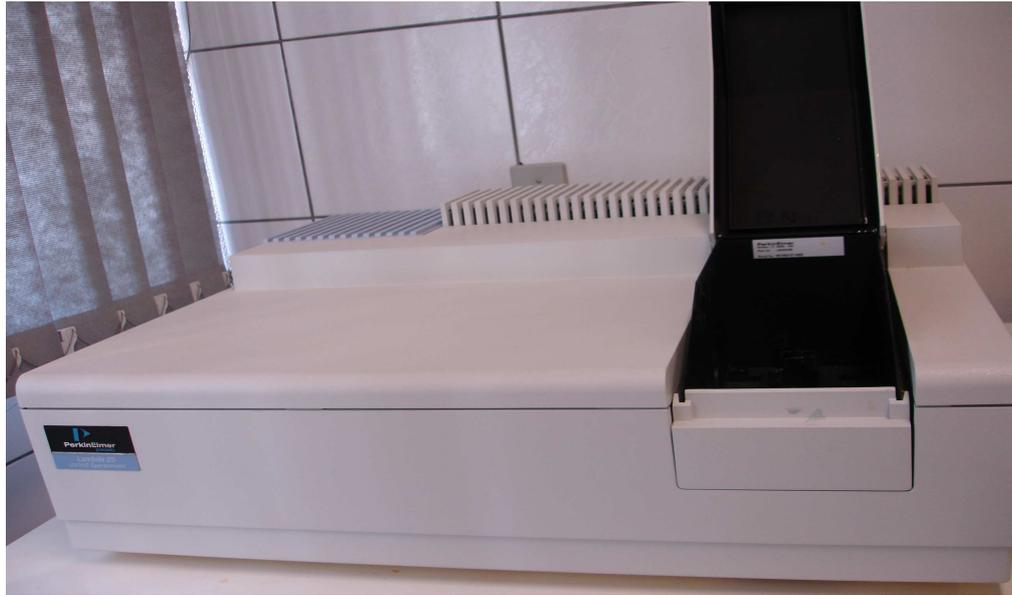
FIGURA 6 - Espectrofotômetro utilizado nos ensaios de varredura UV visível
