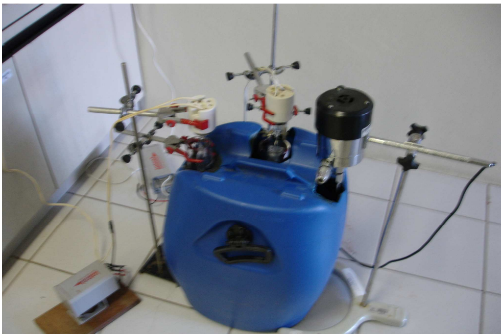
FIGURA 5 - Foto do reator para degradação de resíduos de curtume pelo processo
