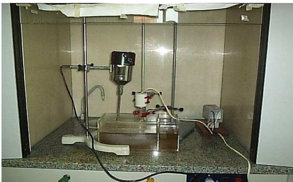
FIGURA 3 - Foto do reator para degradação de resíduos de curtume pelo processo fotoquímico (5L).
