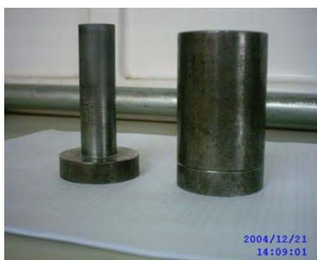
FIGURA 4 – MOLDE UTILIZADO NA COMPACTAÇÃO DOS CORPOS-DE-PROVA CONSTITUÍDO DE 3 PARTES, CILINDRO, PISTÃO E TAMPA.
