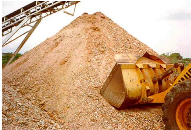
FIGURA 1- ENTULHO PROCESSADO PELA USINA DE RECICLAGEM DE RIBEIRÃO PRETO (ZORDAN, 1997).
