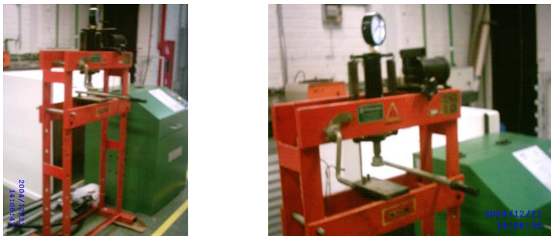
FIGURA 5 – PRENSA MANUAL MARCA SCHULTZ CAPACIDADE DE 15 TONELADAS.
