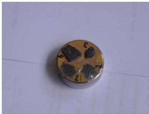
FIGURA 7 – AMOSTRAS PREPARADAS PARA REALIZAÇÃO DO ENSAIO DE MEV.
