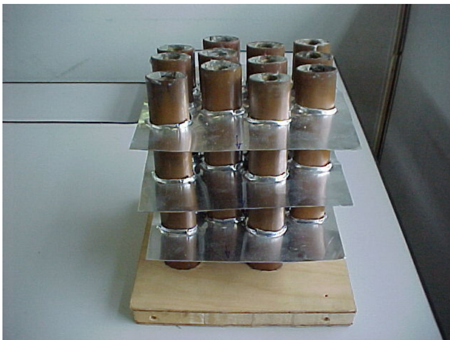
Figura 21 - Montagem do trocador de calor de tubos elípticos
