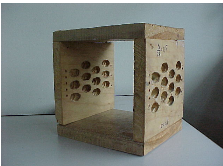
Figura 14 - Módulo em madeira para tubos elípticos
