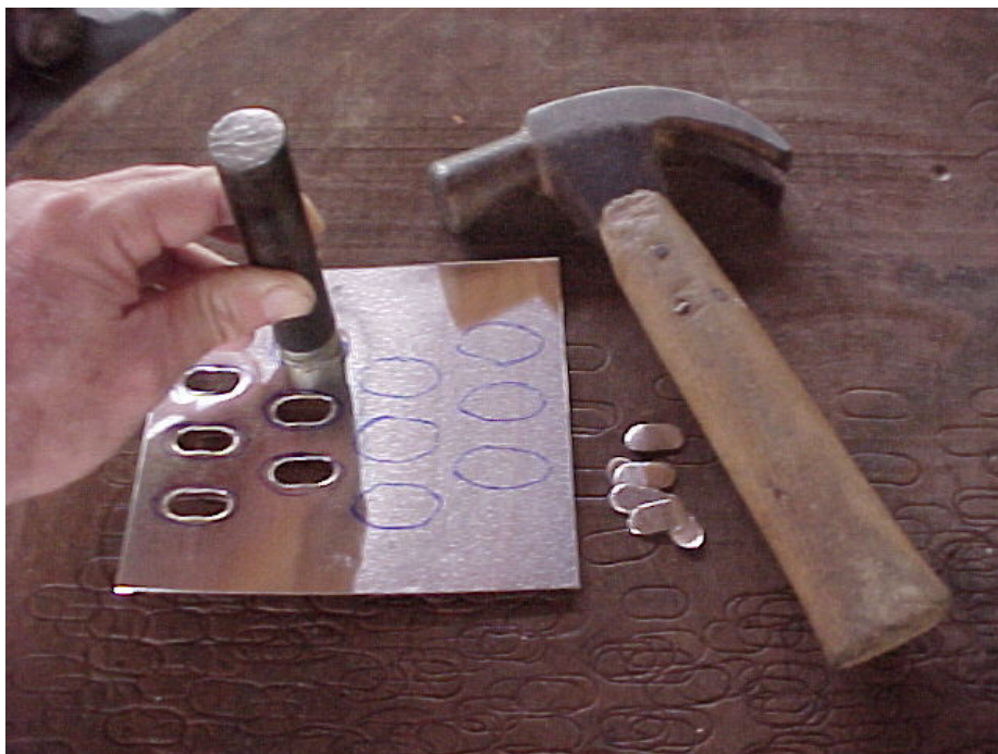
Figura 19 - Corte dos pré-furos elípticos das aletas
