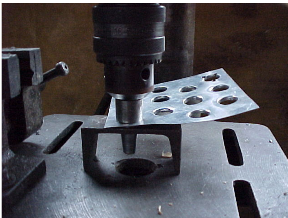
Figura 18 - Conformação dos furos circulares das aletas
