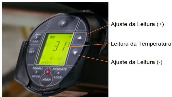
Figura 58: Painel traseiro da Pistola Laser onde a leitura da temperatura.
