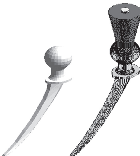
Figura 42: Representação em CAD para uma prótese de quadril acabada (esquerda) e formato semi acabado após a fundição (direita) (WU et al. , 2001).
