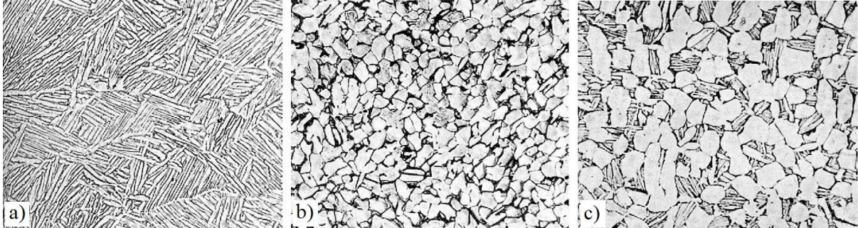
Figura 31: Diferentes microestruturas da liga Ti6Al4V relacionadas com o tratamento térmico a que foi submetida. a) estrutura lamelar, b) estrutura equiaxial e c) estrutura bimodal (lamelar e equiaxial) (adaptado de RACK; QAZI, 2006).
