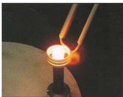
Figura 62: Bobina de indução eletromagnética com a peça a ser aquecida corretamente posicionada, Anexo E. (cortesia Jamo Aquecimento Indutivo).
