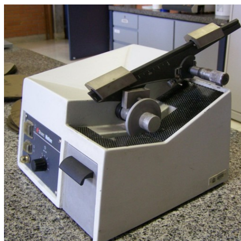
Figura 50: Cortadeira de precisão marca Struers, modelo Minitom, utilizada para cortar os CDP, na dimensão selecionada (Cortesia PUCPR).
