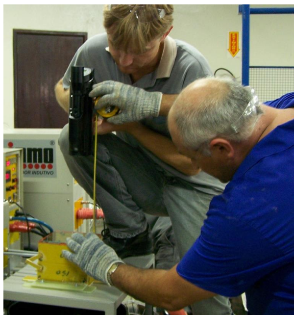
Figura 59: Posicionamento vertical da pistola laser para a medição da temperatura do CDP e confirmação da distância de 300mm.
