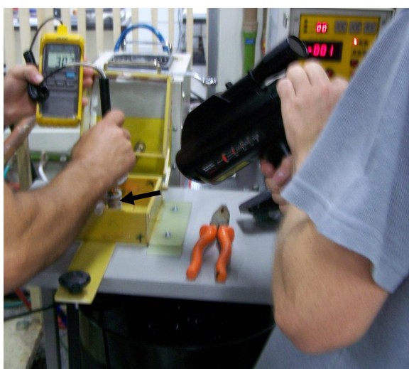
Figura 57: Procedimento de aferição da pistola laser mostrando o termopar exposto de platina (seta) para a leitura por contato.
