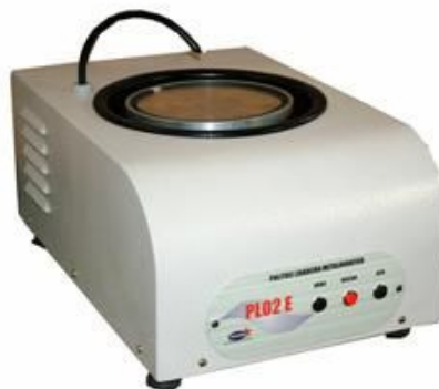
Figura 69: Politriz e lixadeira metalográfica PL02E.
