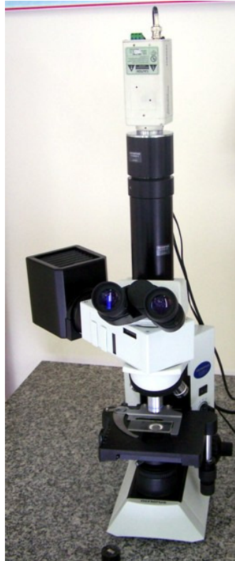
Figura 70: Microscópio Óptico (MO) utilizado, com capacidade de ampliação de 40x, 100x, 200x e 400x.
