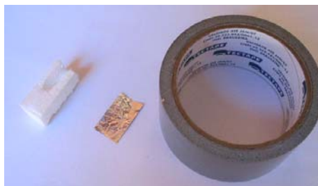
Figura 3.13: Poliestireno expandido, folha aluminizada e fita Tec-Tape.
