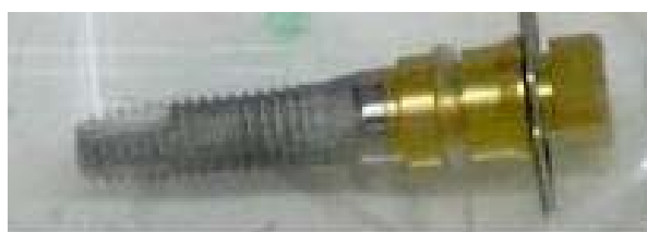
Figura 2 - Amostra do implante Serson Implus com montador.
