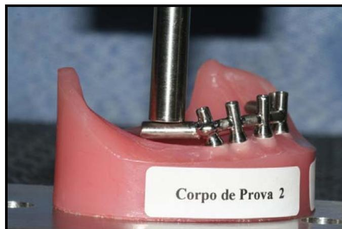
Figura 24 - Fotografia do Lado direito da barra soldada a laser no momento da aplicação de força.
