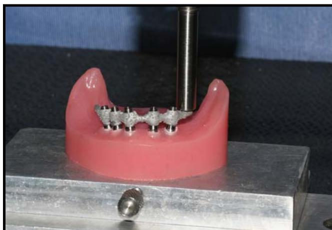
Figura 21 - Fotografia da Imagem do modelo posicionado na EMIC para aplicação de carga.
