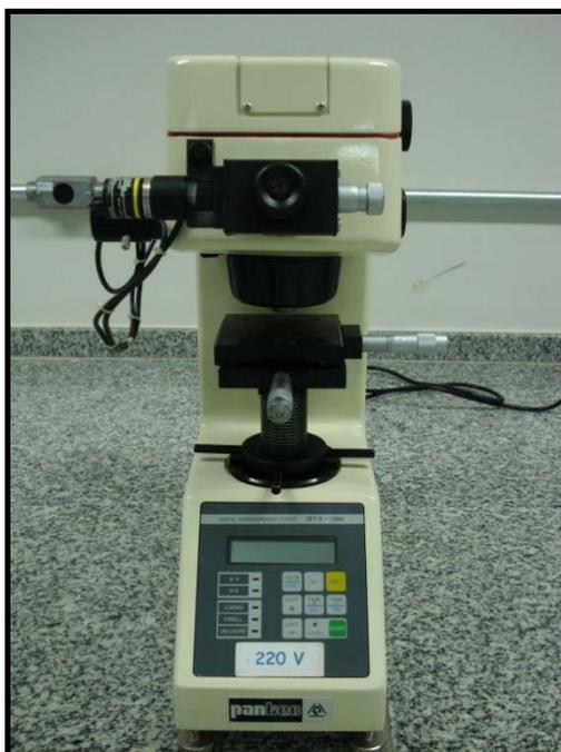
Figura 17 - Fotografia do Aparelho microdurômetro utilizado para mensuração da desadaptação após a aplicação das cargas cíclicas.
