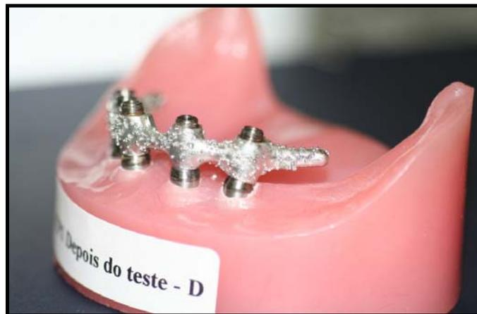
Figura 28 - Fotografia do lado esquerdo da barra fundida após a aplicação da força (não houve deformação aparente, nem perda do assentamento da barra).
