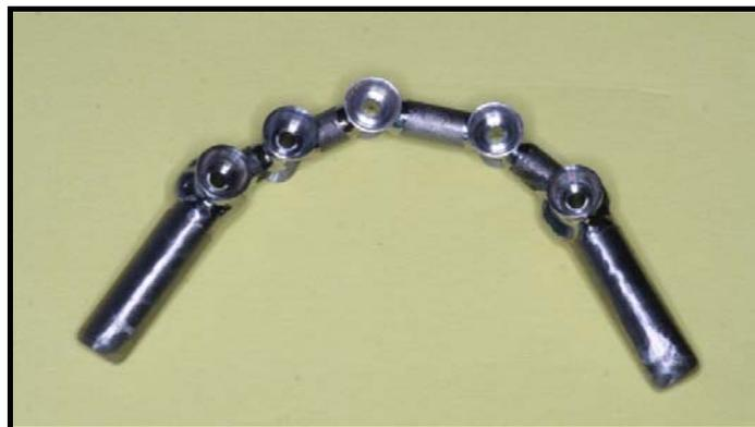
Figura 13 - Fotografia da Barra soldada a laser (visão inferior).
