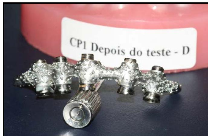
Figura 29 - Fotografia da Imagem da infra-estrutura de Cr-Co, após a finalização dos testes.
