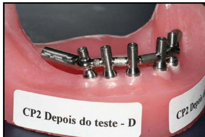
Figura 31 - Fotografia do lado direito da barra soldada a laser após a aplicação da força (não houve deformação aparente, nem perda do assentamento da barra).
