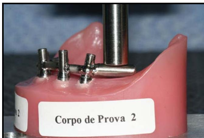
Figura 25 - Fotografia do lado esquerdo da barra soldada a laser no momento da aplicação de força.
