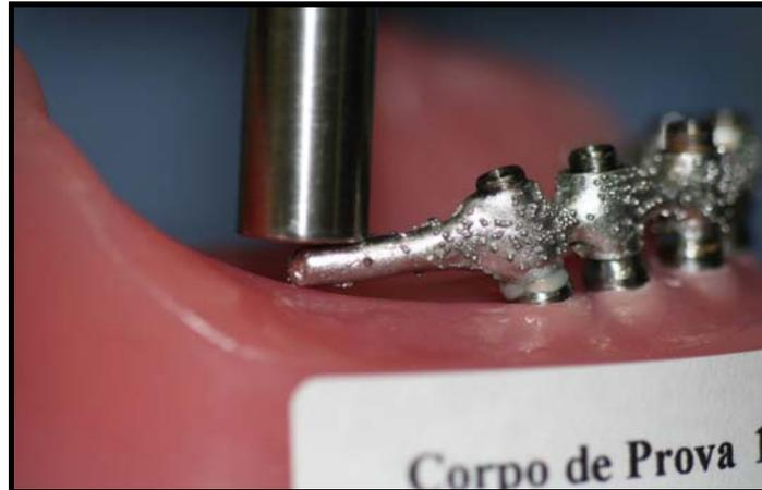
Figura 22 - Fotografia do Lado direito da barra fundida no momento da aplicação de força.
