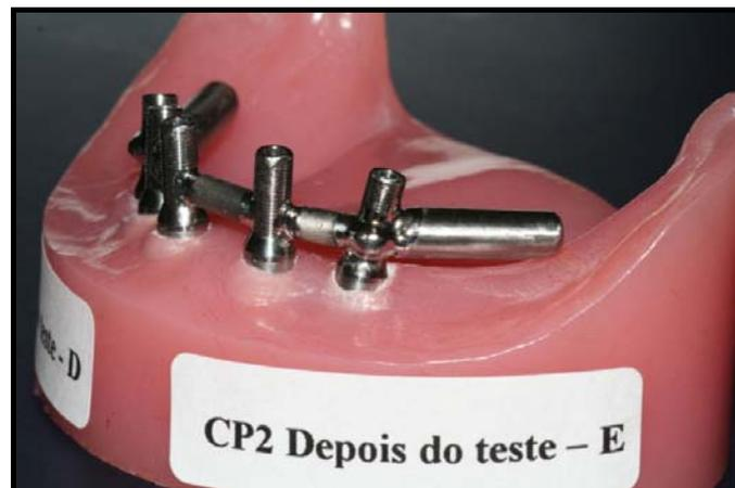
Figura 32 - Fotografia do lado esquerdo da barra soldada a laser após a aplicação da força (não houve deformação aparente, nem perda do assentamento da barra).
