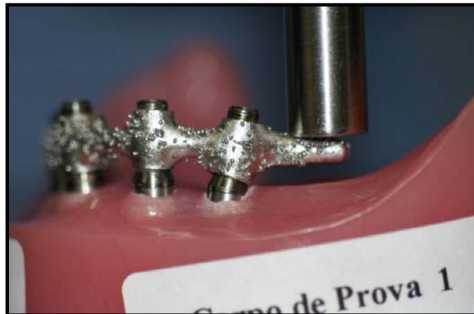
Figura 23 - Fotografia do Lado esquerdo da barra fundida no momento da aplicação de força.
