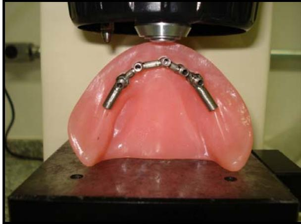
Figura 18 - Fotografia do Modelo no microscópio para mensuração das distâncias análogo/cilindro.
