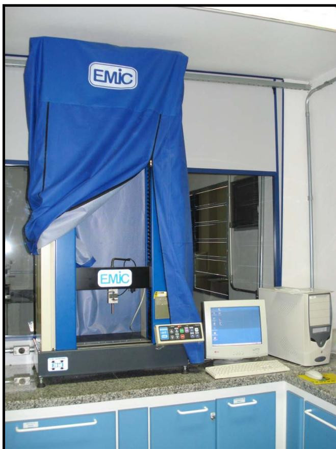
Figura 1 - Fotografia da Máquina para ensaios universal EMIC 2000, pertencente a C.P.O. São Leopoldo Mandic, computador para análise dos dados (software TESC, versão 3.01).
